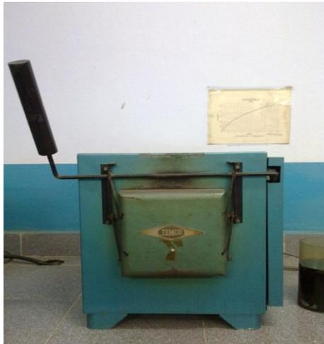
**Figura 3. 3 Horno para realizar el tratamiento térmico**
