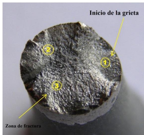
**Figura 4. 16** Macrografía del Acero AISI 1045. Condición normalizado a bajo ciclaje (S= 383,55 Mpa)
