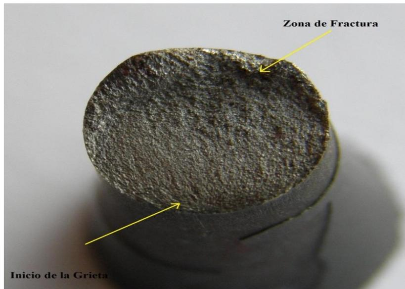
**Figura 4. 14 Macrofotografía de Acero AISI 1045. Condición normalizado sometidas a fatiga en alto ciclaje ( $S=233,64$  MPa)**
