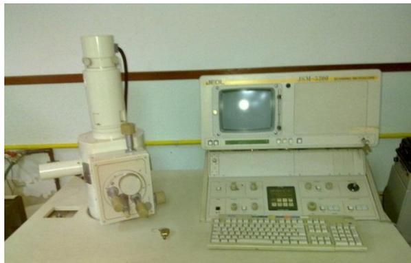
**Figura 3. 7 Microscopio electrónico de barrido**
