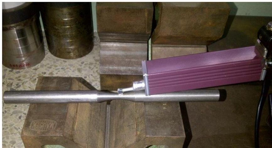
**Figura 3. 2** Ejemplo de la muestra siendo medida en el rugosímetro
