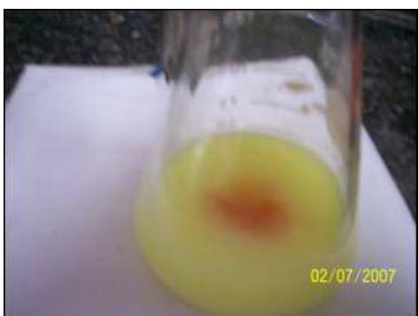
Figura 3.23 Detalle de la titulación y donde se nota la proximidad del punto final.
