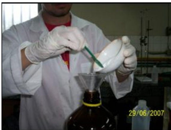
Figura 3.9 Preparación de la solución Acondicionadora (Agregando 75 g de NaCl).
