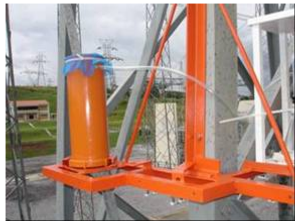
Figura 3.6. Colector de Polvos Atmosféricos
