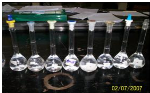
Figura 3.10. Balones aforados a 100 ml con soluciones patrón de sulfato
