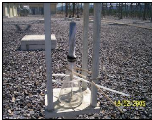
Figura 3.4. Colector de Cloruros.
