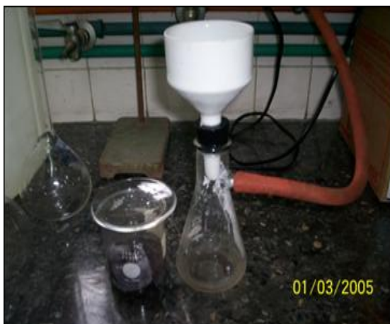
Figura 3.16. Filtrado de la muestra al vacío
