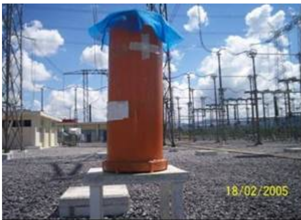
Figura 3.5. Colector de Polvos Atmosféricos
