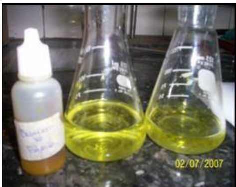
Figura 3.21. Alícuotas de solución patrón de NaCl con cromato de potasio.
