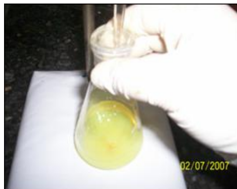
Figura 3.22 Titulación de la solución patrón de NaCl con solución estándar de Nitrato de Plata
