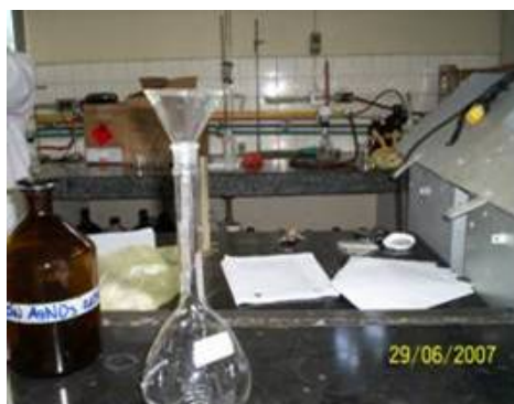
Figura 3.20. Preparación de la solución estándar de Nitrato de Plata.
