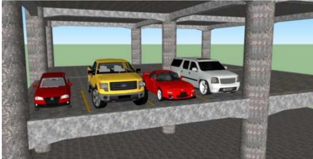
Figura 26. Distribución de Columnas en los modelos estructurales de luz de entre pórticos de 11.20 m Nota. Datos tomados de Randolf U. y Aturo R. (2012, Mayo).
