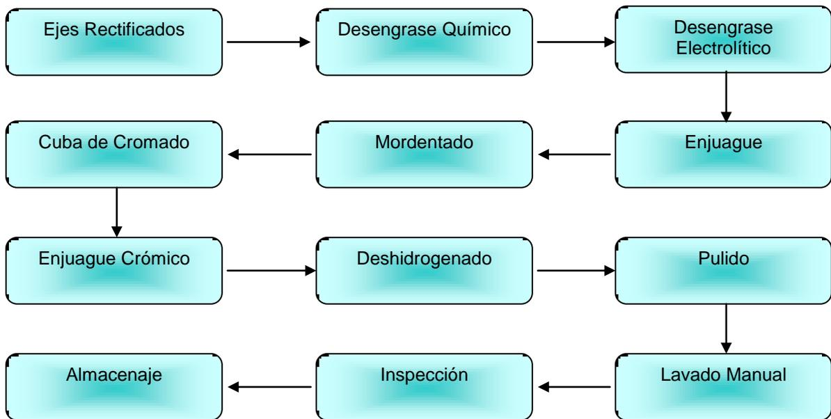
**FIGURA 1.1 DIAGRAMA DE BLOQUES DEL PROCESO DE CROMADO EN UNA EMPRESA FABRICANTE DE AMORTIGUADORES**
