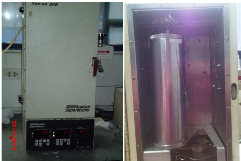
**Figura 3.4.** Equipo de extracción con fluido supercrítico (Der.) y vaso extractor del FSC (Izq.).
