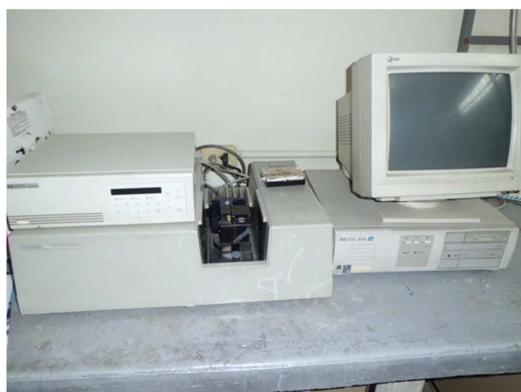
**Figura 3.6.** Espectrofotómetro UV-Visible
