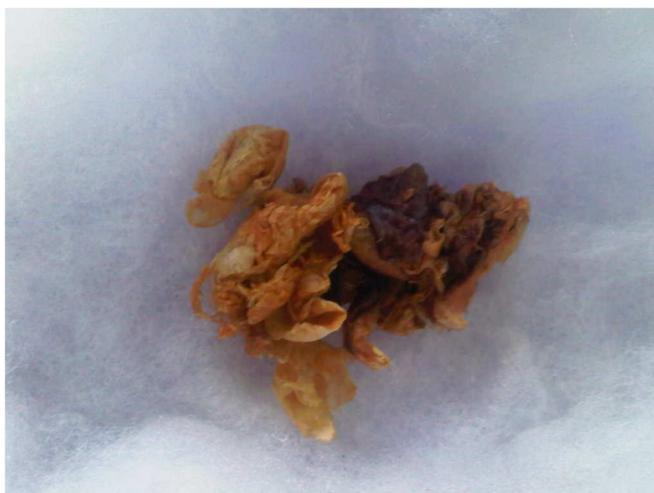
**Figura 4.7.** Muestra que resulto quemada utilizada en la extracción con fluido supercrítico.
