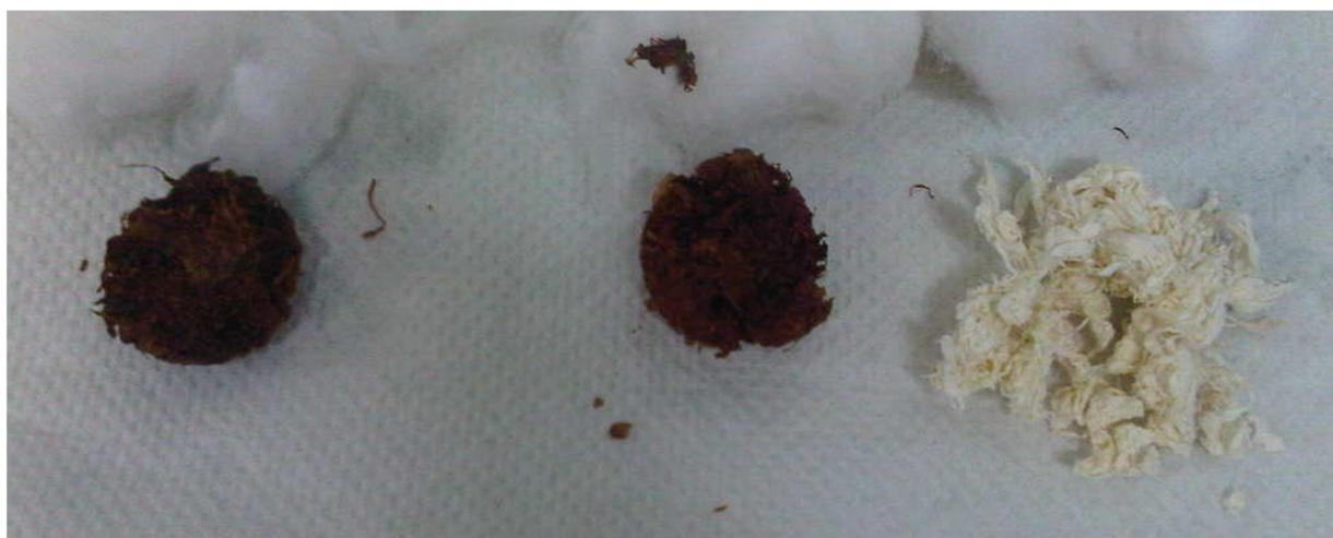
**Figura 4.1.** Muestra liofilizada cuando se finaliza la extracción por el método Soxhlet, utilizando éter de petróleo, hexanos y etanol, de izquierda a derecha.
