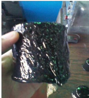
Figura N° 20 Exceso de pintura
