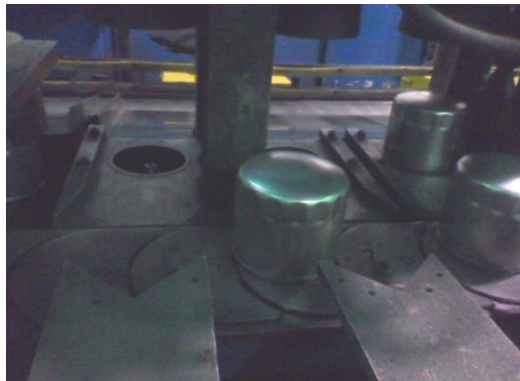
Figura Nº 17 Mal posicionamiento por freno averiado
