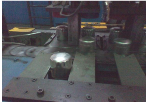
Figura Nº 16 Mal posicionamiento de entrada al equipo
