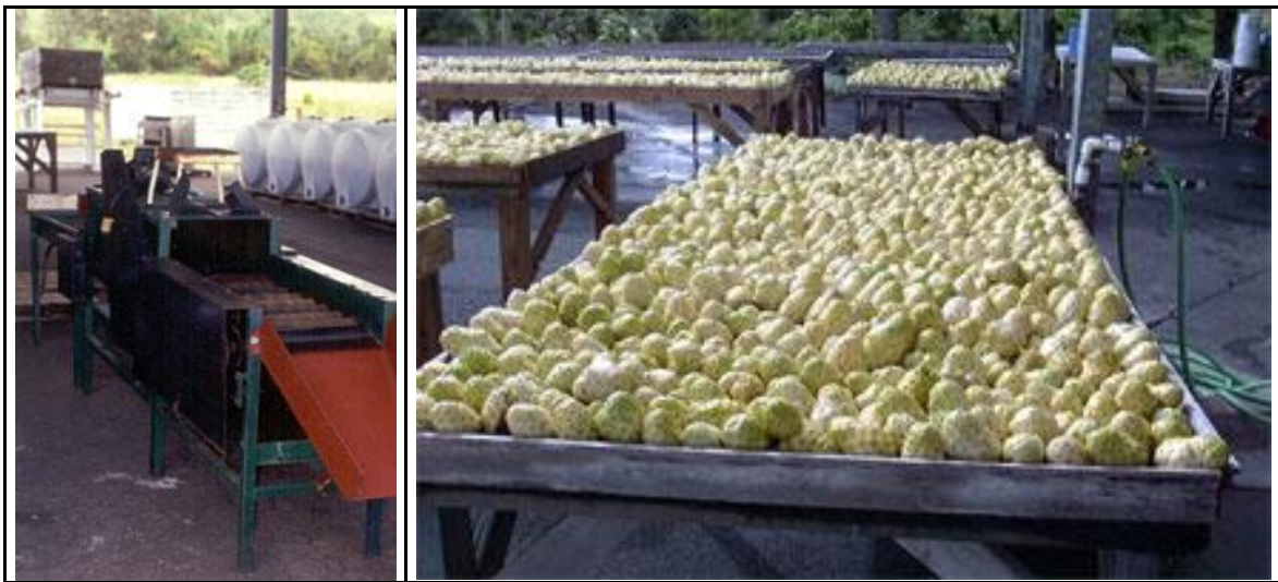
Figura 2.3. De izquierda a derecha. Equipo de lavado de fruta noni automático, utilizado generalmente para el lavado de tomates. Las frutas de noni luego de ser lavadas son colocadas en mesones escurridores, antes de ser procesadas. Fuente: Scot, 2002.
