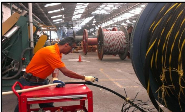
**FIGURA 5.20** PREPARACIÓN DE PUNTAS DE CABLES
