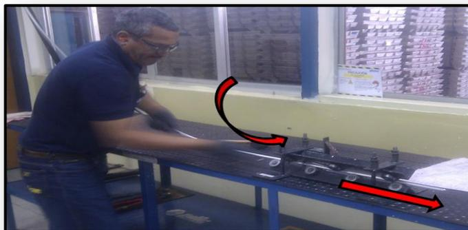
**FIGURA 5.12** ENDEREZAMIENTO MANUAL DEL ALAMBRE
