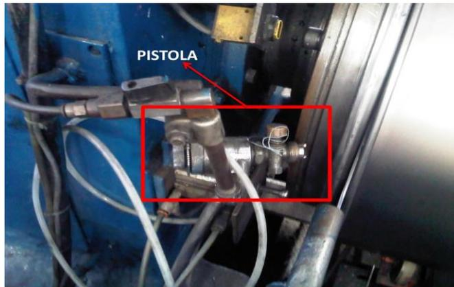
**Figura N° 13.** Pistola de aplicación de lubricante de la grafadora.
