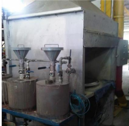
**Figura N° 16.** Área de aplicación de pintura de tapas y fondos revestidos
