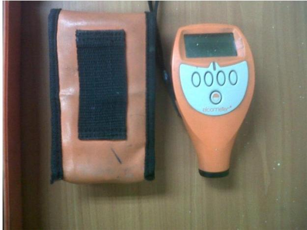
**Figura N° 9.** Medidor de espesor
