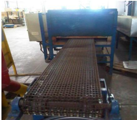
**Figura N° 17.** Área de curado de tapas y fondos revestidos
