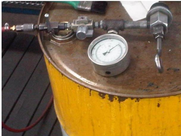
**Figura N° 10.** Pistola medidora de fuga
