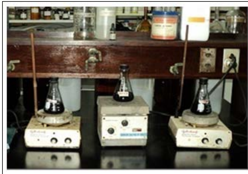
Figura 4.35. Adsorción sobre carbón activado de soluciones de ácido acético diluidas
