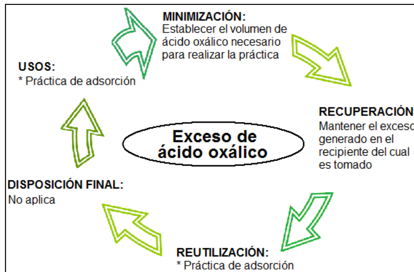
Figura 4.26. Etapas del manejo del exceso de ácido oxálico aplicando un análisis de ciclo cerrado.
