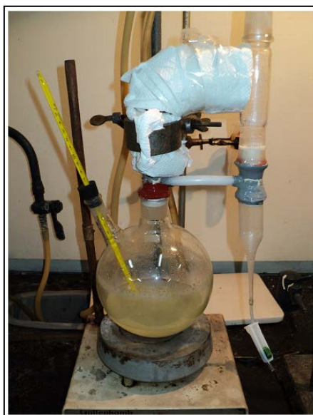
Figura 3.5. Montaje experimental del sistema de recuperación de tolueno con recirculación.
