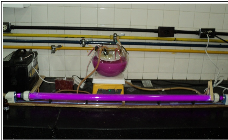
Figura 3.4. Montaje experimental del sistema fotocatalítico utilizando lámpara UV con una longitud de onda de 368 nm.
