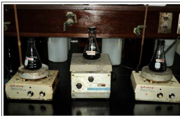
Figura 3.6. Montaje experimental utilizado para la adsorción de ácido acético sobre carbón activado.
