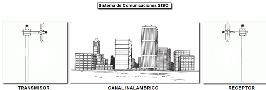
Figura 3.9: Sistema de Comunicaciones SISO
