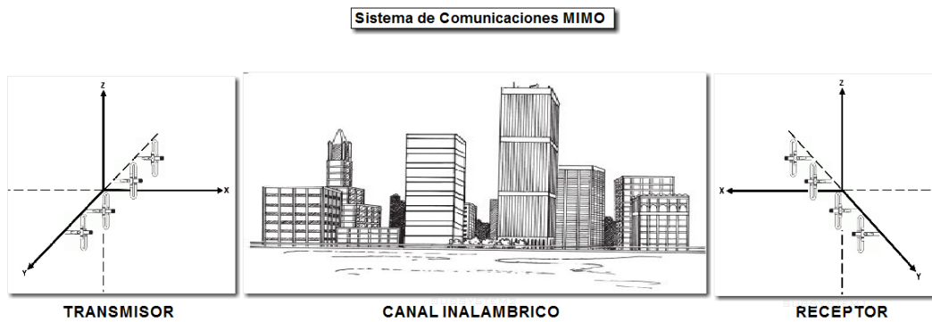
Figura 3.1: Modelo de Sistema con Antenas MIMO
