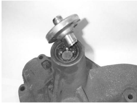
**Figura n° 2.11.** Rotura limpia, indica una fractura “instantánea” causada por la sobrecarga repentina o fuera de balance
