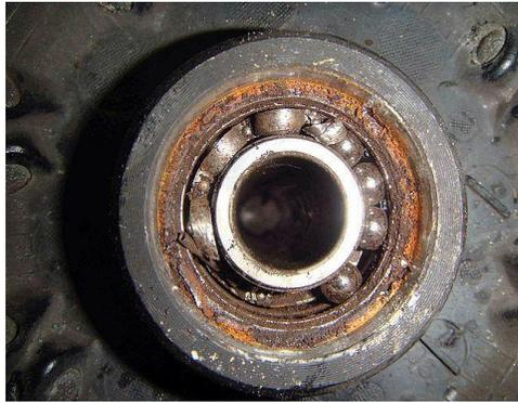
**Figura 2.13.** Rodamiento en condición crítica de desgaste.
