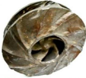
**Figura n° 2.12. Fractura notable del impulsor, en la zona del eje**
