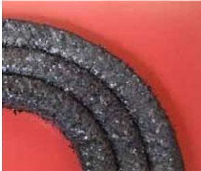
**Figura 2.9.** Empaquetadura desgastada
