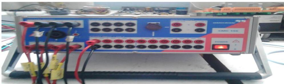
Figura 4.19 Ilustración de las conexiones en el banco de prueba CMC 156. Fuente: Milano Rodríguez (2016)
