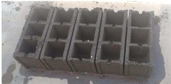
Figura 6. Bloques de concreto estructural tipo E1
