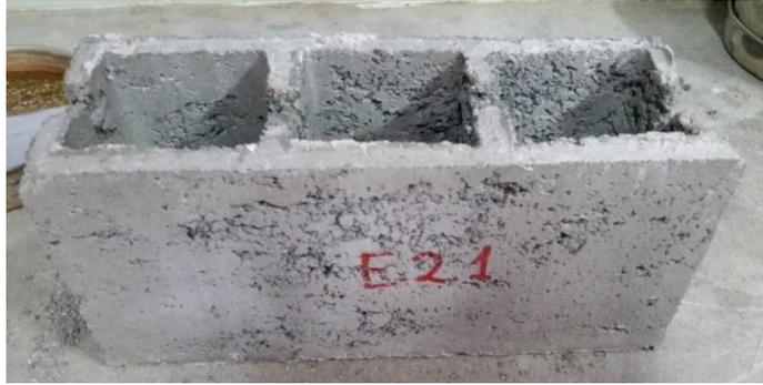
Figura 7. Bloques de concreto estructural tipo E2
