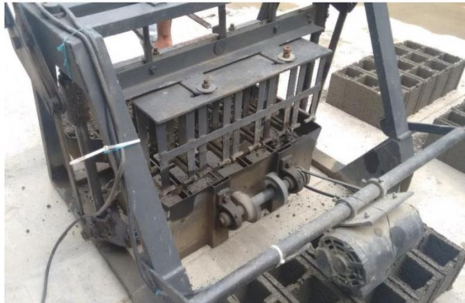
Figura 4. Máquina ponedora de bloques
