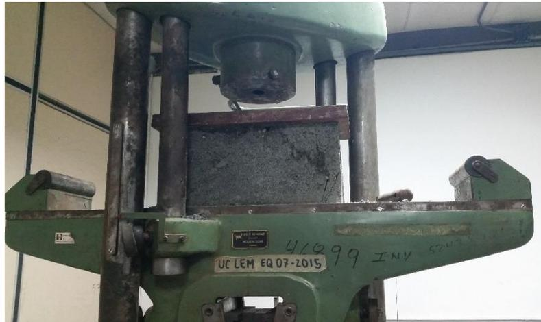
Figura 12. Máquina de ensayo para la determinación de la resistencia a la compresión de los bloques de concreto
