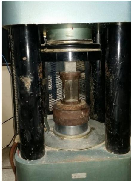
Figura 11. Máquina de ensayo para la determinación de la resistencia a la compresión de las probetas cúbicas
