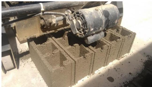
Figura 8. Bloques de concreto estructural tipo E3
