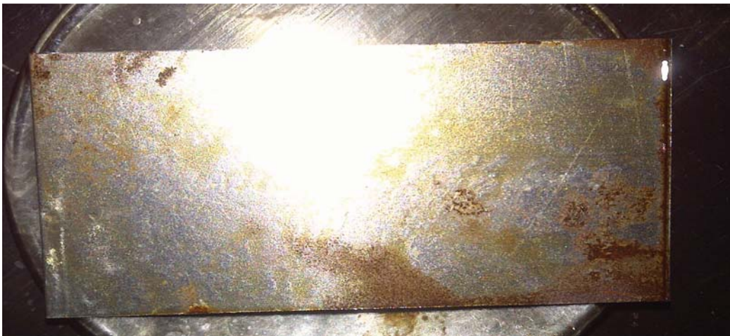
Anexo A.47. Remoción de aceite mineral con el producto F3 (Fenilsulfonato LAS 50), en la superficie de hierro comercial (final).
