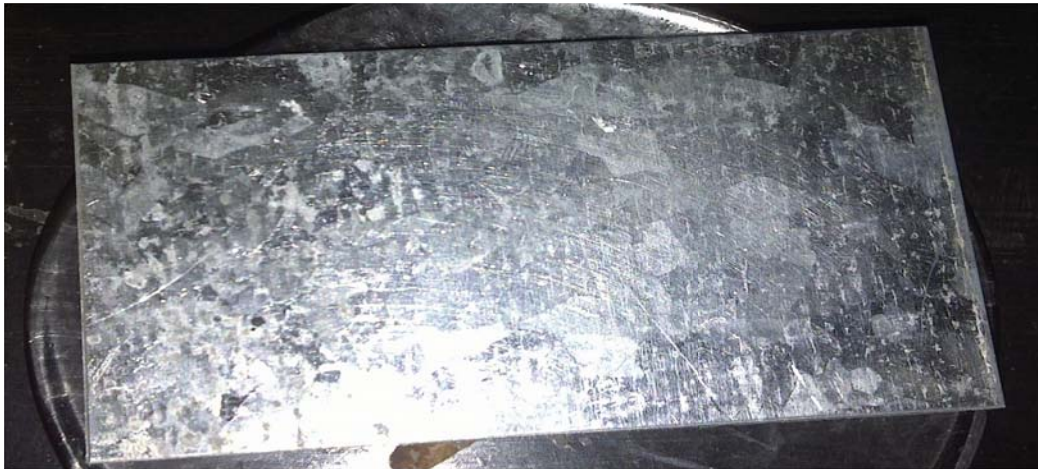
Anexo A.57. Remoción de aceite vegetal reciclado con el producto F1 (Genapol BD), en la superficie de hierro galvanizado (final).
