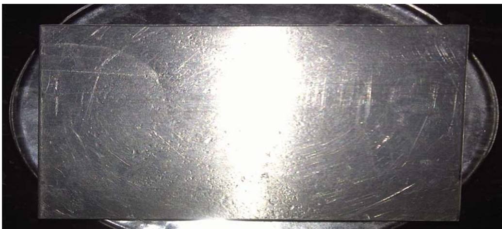
Anexo A.19. Remoción de aceite vegetal con el producto F1 (Genapol BD), en la superficie de aluminio (final).
