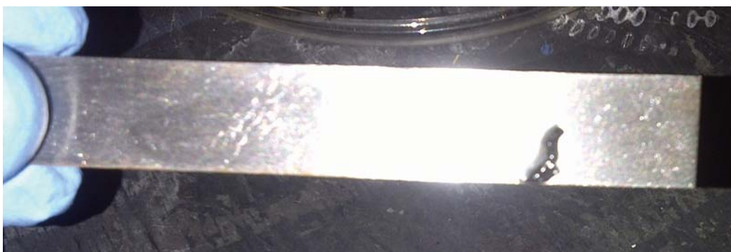
Anexo A.146. Lámina de hierro corroída por el producto F2 (Hostapur SAS 60 y Arkopal N 100), al séptimo día.
