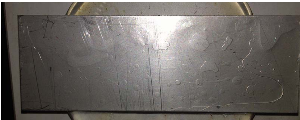
Anexo A.83. Remoción de aceite vegetal reciclado con el producto F1 (Fenilsulfonato LAS 50), en la superficie de acero (inicial).
