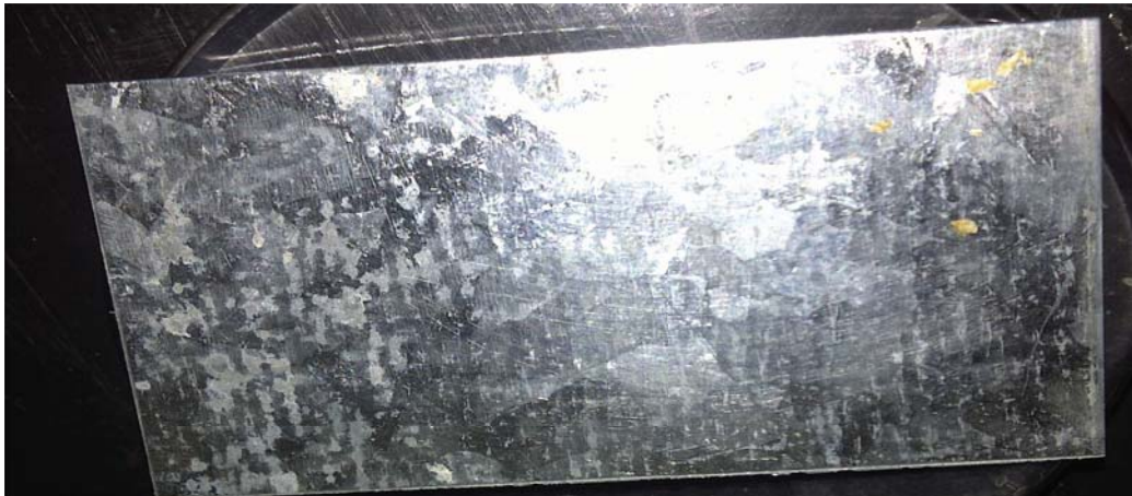
Anexo A.63. Remoción de aceite vegetal reciclado con el producto F2 (Hostapur SAS 60 y Arkopal N 100), en la superficie de hierro galvanizado (final).
