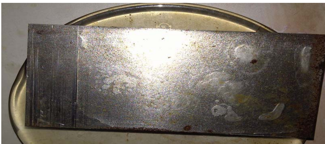
Anexo A.44. Remoción de aceite vegetal reciclado con el producto F2 (Hostapur SAS 60 y Arkopal N 100), en la superficie de hierro comercial (inicial).
