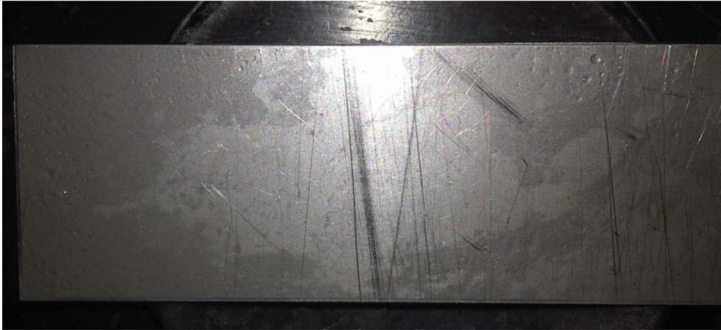
Anexo A.15. Remoción de aceite vegetal reciclado con el producto F3 (Fenilsulfonato LAS 50), en la superficie de acero (final).
