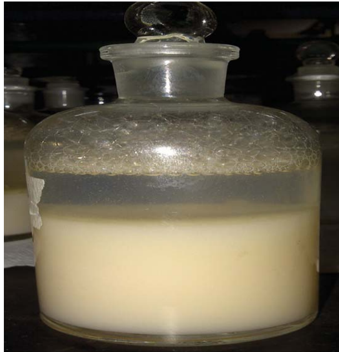
Anexo A.119. Producto F2 (Hostapur SAS 60 y Arkopal N100), al 11vo día de estudio, con la adición de sulfato de manganeso y solución de álcali-yoduro-azida.
