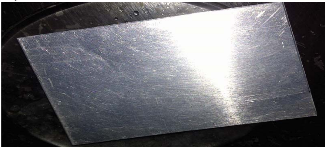
Anexo A.33. Remoción de aceite vegetal reciclado con el producto F3 (Fenilsulfonato LAS 50), en la superficie de aluminio (final).
