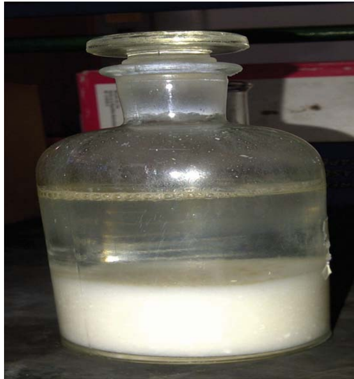
Anexo A.131. Producto F3 (Fenilsulfonato LAS 50), al 15vo día de estudio, con la adición de sulfato de manganeso y solución de álcali-yoduro-azida.
