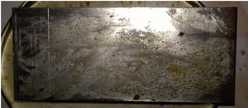
Anexo A.50. Remoción de aceite vegetal reciclado con el producto F3 (Fenilsulfonato LAS 50), en la superficie de hierro comercial (inicial).
