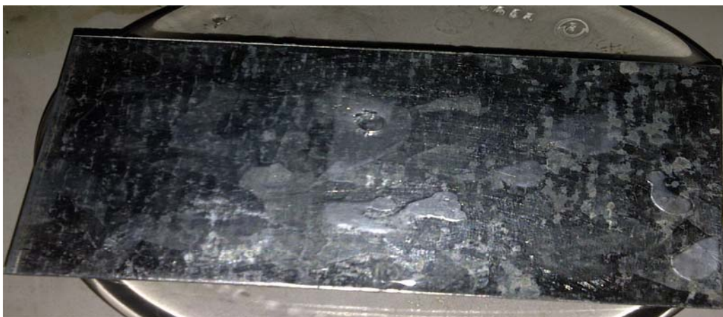
Anexo A.56. Remoción de aceite vegetal reciclado con el producto F1 (Genapol BD), en la superficie de hierro galvanizado (inicial).
