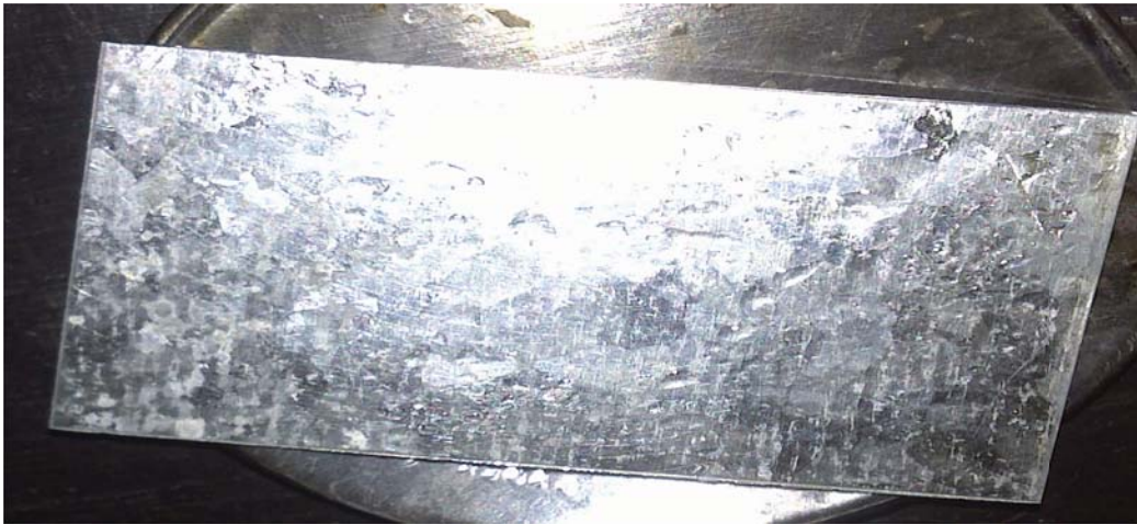
Anexo A.61. Remoción de aceite vegetal con el producto F2 ((Hostapur SAS 60 y Arkopal N 100), en la superficie de hierro galvanizado (final).
