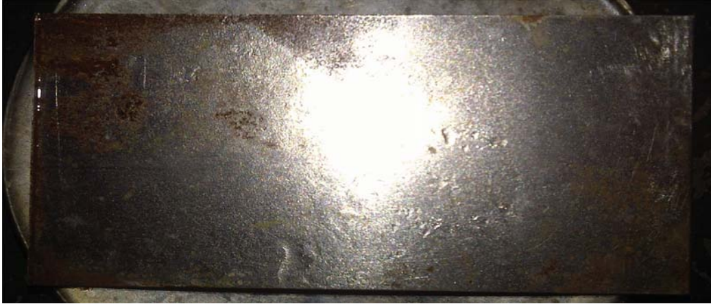
Anexo A.45. Remoción de aceite vegetal reciclado con el producto F2 (Hostapur SAS 60 y Arkopal N 100), en la superficie de hierro comercial (final).
