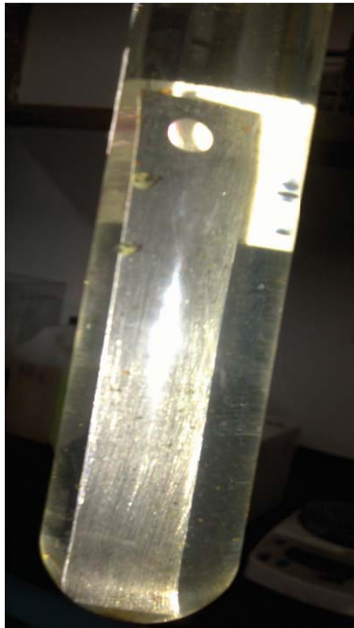
Anexo A.142. Lámina de hierro sumergida en una solución del producto F1 (Genapol BD), al séptimo día.
