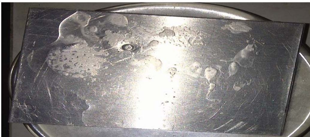
Anexo A.26. Remoción de aceite vegetal reciclado con el producto F2 (Hostapur SAS 60 y Arkopal N 100), en la superficie de aluminio (inicial).
