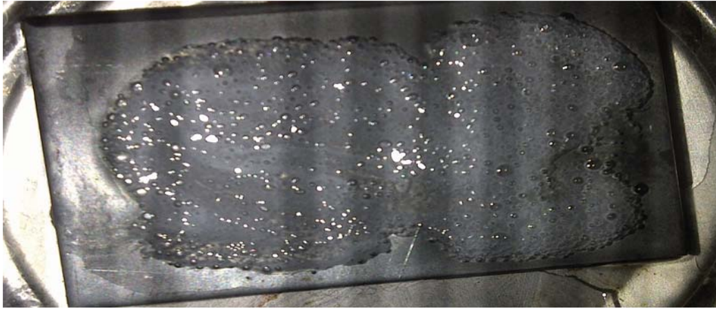
Anexo A.78. Remoción de aceite vegetal reciclado con el producto F3 (Fenilsulfonato LAS 50), en la superficie de hierro negro (inicial).
