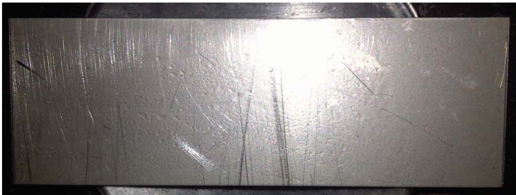
Anexo A.8. Remoción de aceite vegetal con el producto F2 ((Hostapur SAS 60 y Arkopal N 100), en la superficie de acero (final).
