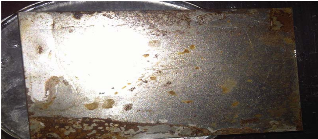
Anexo A.102. Remoción de aceite vegetal reciclado con el producto F1 (Fenilsulfonato LAS 50), en la superficie de hierro comercial (final).
