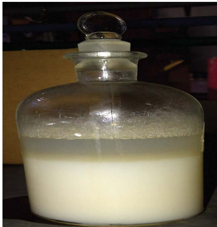
Anexo A.128. Producto F2 (Hostapur SAS 60 y Arkopal N100), al 15vo día de estudio, con la adición de sulfato de manganeso y solución de álcali-yoduro-azida.
