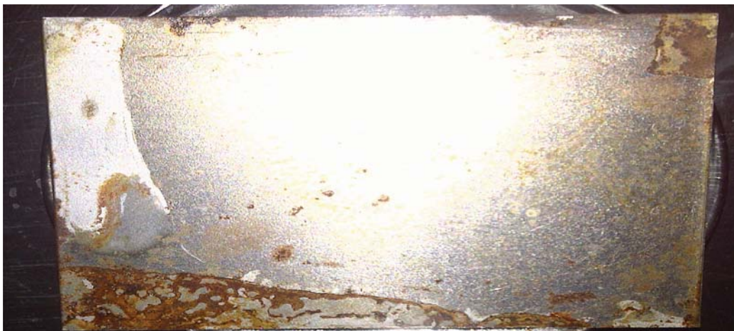
Anexo A.100. Remoción de aceite vegetal con el producto ULTRA CLEAN, en la superficie de hierro comercial (final).
