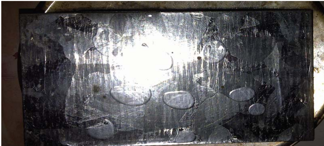
Anexo A.54. Remoción de aceite vegetal con el producto F1 (Genapol BD), en la superficie de hierro galvanizado (inicial).
