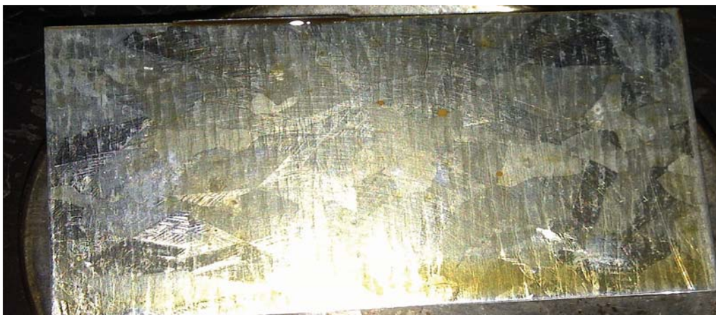
Anexo A.53. Remoción de aceite mineral con el producto F1 (Genapol BD), en la superficie de hierro galvanizado (final).
