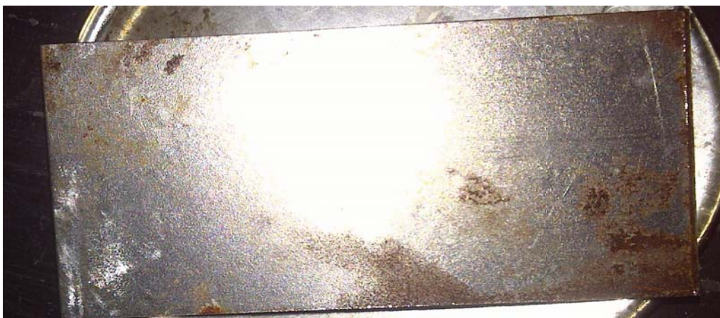
Anexo A.37. Remoción de aceite vegetal con el producto F1 (Genapol BD), en la superficie de hierro comercial (final).
