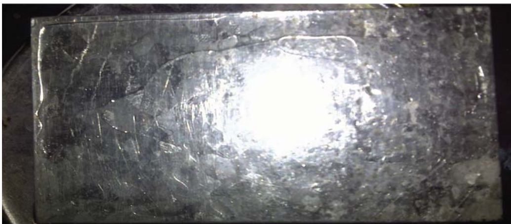
Anexo A.89. Remoción de aceite vegetal reciclado con el producto F1 (Fenilsulfonato LAS 50), en la superficie de hierro galvanizado (inicial).
