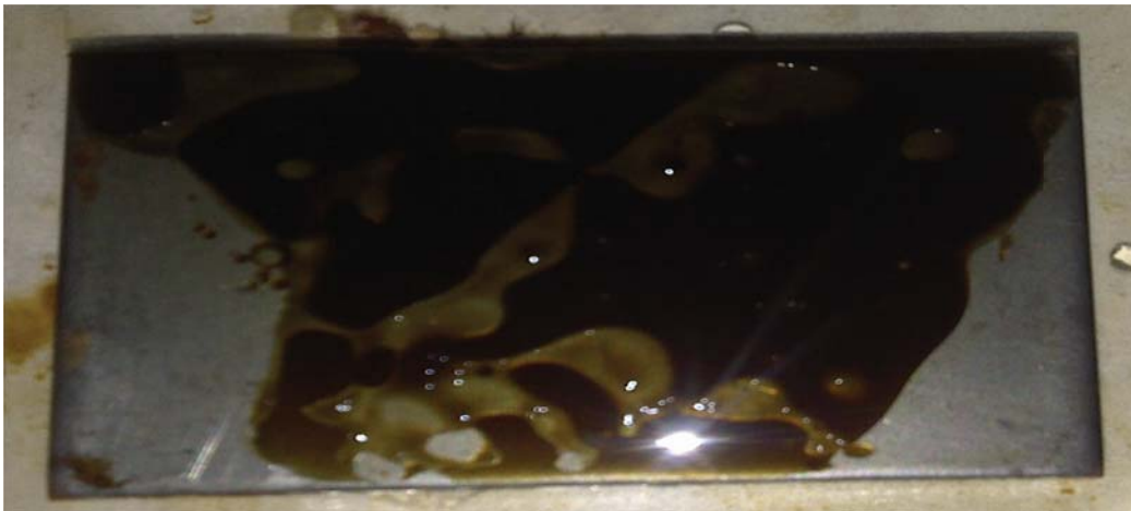
Anexo A.91. Remoción de aceite mineral con el producto ULTRA CLEAN, en la superficie de hierro negro (inicial).
