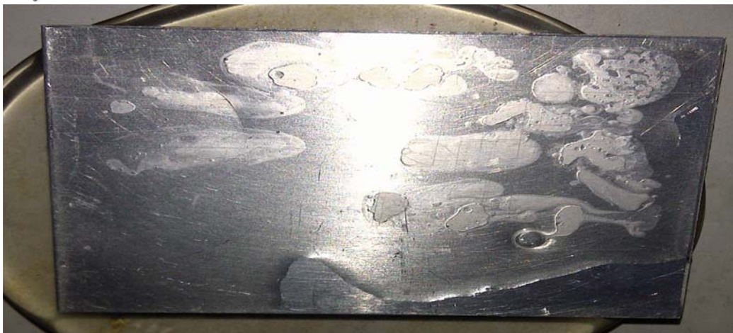
Anexo A.24. Remoción de aceite vegetal con el producto F2 ((Hostapur SAS 60 y Arkopal N 100), en la superficie de aluminio (inicial).
