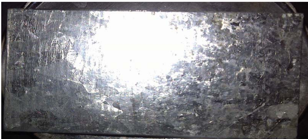
Anexo A.88. Remoción de aceite vegetal con el producto ULTRA CLEAN, en la superficie de hierro galvanizado (final).
