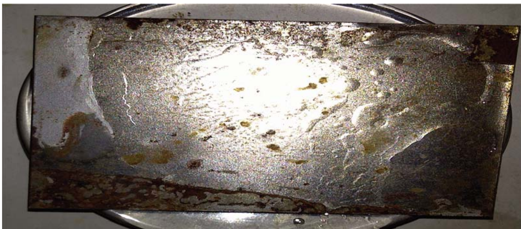
Anexo A.101. Remoción de aceite vegetal reciclado con el producto F1 (Fenilsulfonato LAS 50), en la superficie de hierro comercial (inicial).
