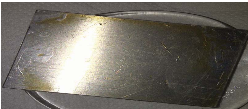
Anexo A.23. Remoción de aceite mineral con el producto F2 (Hostapur SAS 60 y Arkopal N 100), en la superficie de aluminio (final).
