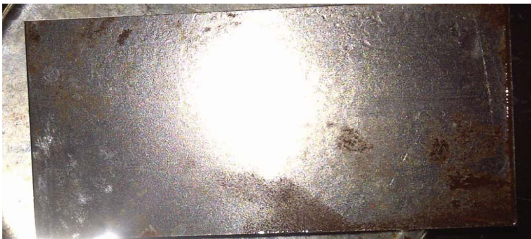
Anexo A.43. Remoción de aceite vegetal con el producto F2 ((Hostapur SAS 60 y Arkopal N 100), en la superficie de hierro comercial (final).
