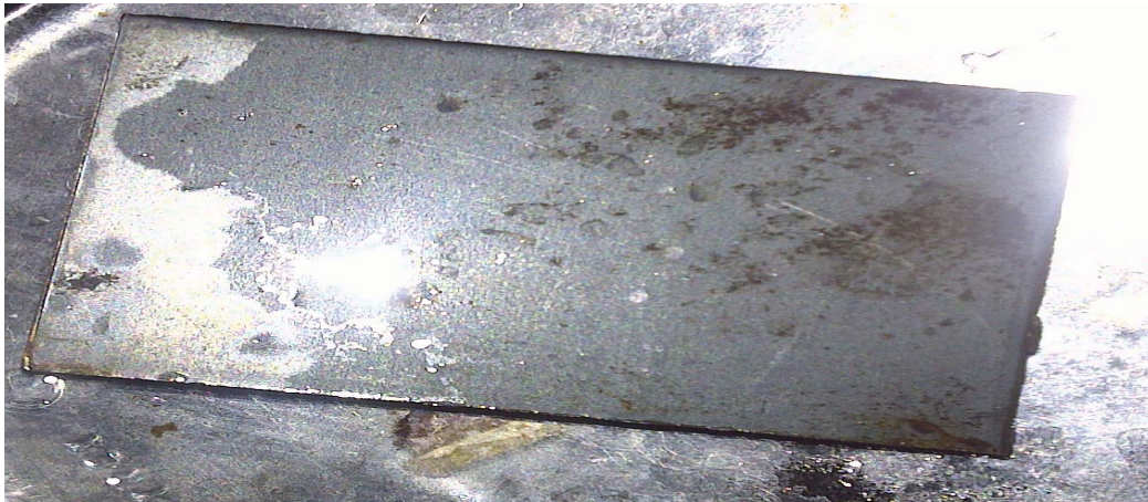
Anexo A.96. Remoción de aceite vegetal reciclado con el producto F1 (Fenilsulfonato LAS 50), en la superficie de hierro negro (final).
