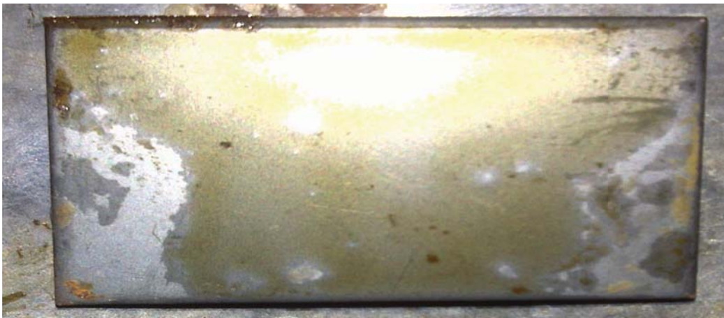
Anexo A.92. Remoción de aceite mineral con el producto ULTRA CLEAN, en la superficie de hierro negro (final).
