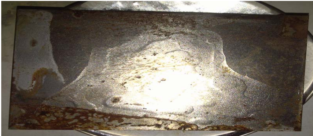
Anexo A.99. Remoción de aceite vegetal con el producto ULTRA CLEAN, en la superficie de hierro comercial (inicial).
