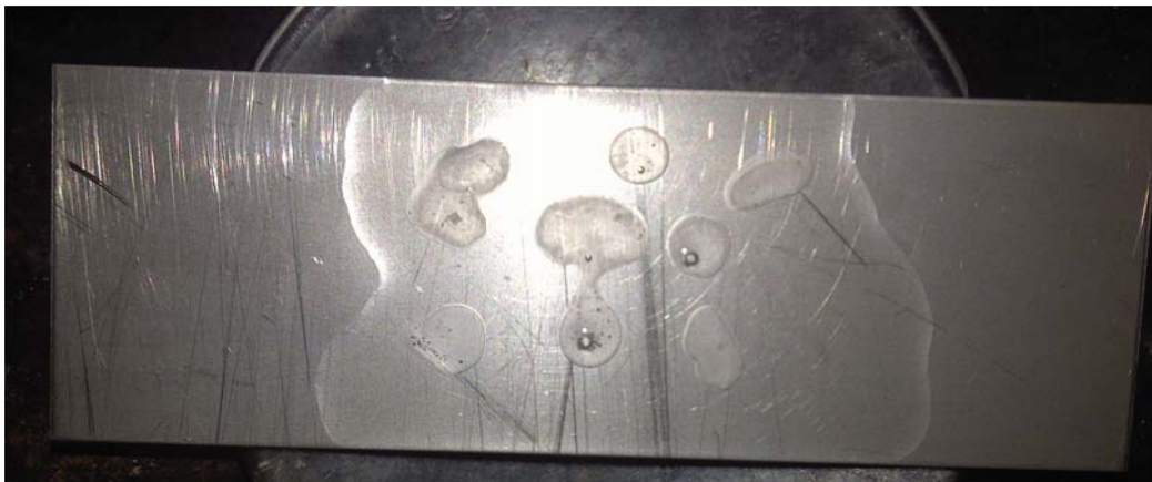
Anexo A.7. Remoción de aceite vegetal con el producto F2 ((Hostapur SAS 60 y Arkopal N 100), en la superficie de acero (inicial).
