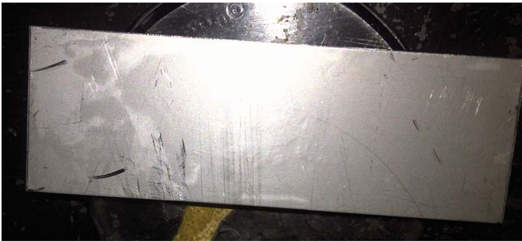
Anexo A.82. Remoción de aceite vegetal con el producto ULTRA CLEAN, en la superficie de acero (final).
