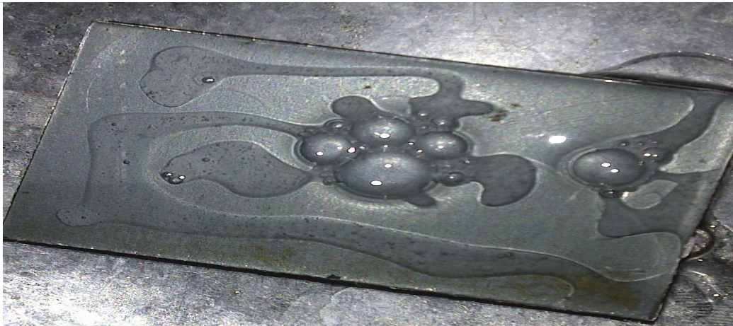
Anexo A.72. Remoción de aceite vegetal reciclado con el producto F1 (Genapol BD), en la superficie de hierro negro.
