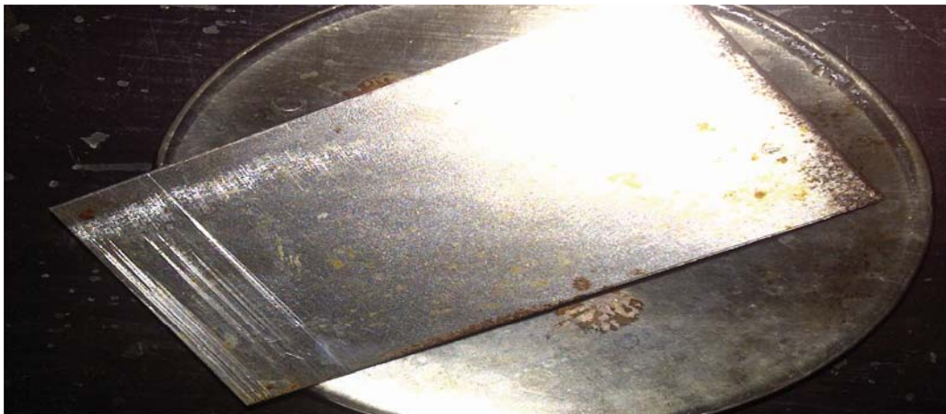
Anexo A.49. Remoción de aceite vegetal con el producto F3 (Fenilsulfonato LAS 50), en la superficie de a hierro comercial (final).
