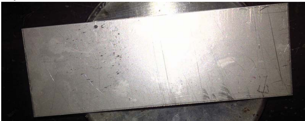
Anexo A.84. Remoción de aceite vegetal reciclado con el producto F1 (Fenilsulfonato LAS 50), en la superficie de acero (final).
