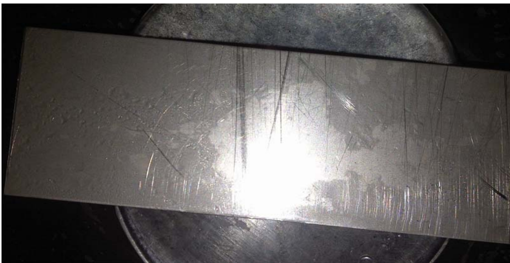
Anexo A.5. Remoción de aceite vegetal reciclado con el producto F1 (Genapol BD), en la superficie de acero acero (final).
