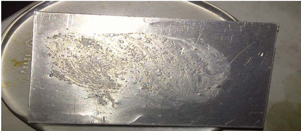
Anexo A.30. Remoción de aceite vegetal con el producto F3 (Fenilsulfonato LAS 50), en la superficie de aluminio (inicial).
