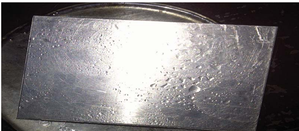
Anexo A.25. Remoción de aceite vegetal con el producto F2 ((Hostapur SAS 60 y Arkopal N 100), en la superficie de aluminio (final).
