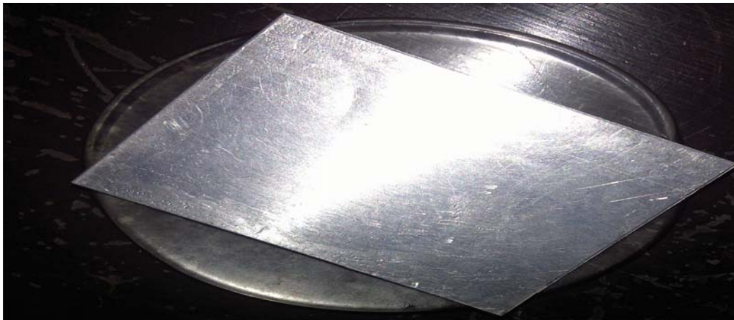
Anexo A.31. Remoción de aceite vegetal con el producto F3 (Fenilsulfonato LAS 50), en la superficie de a aluminio (final).
