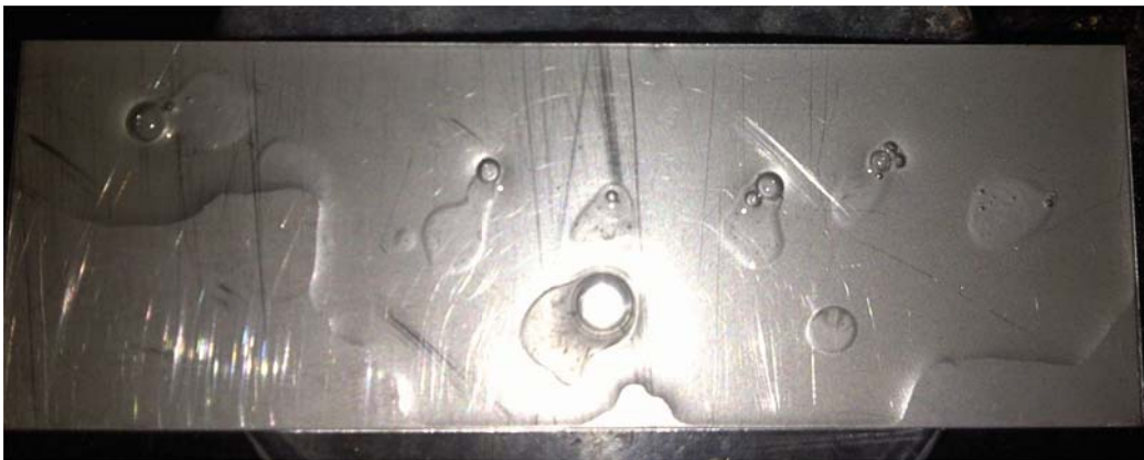
Anexo A.4. Remoción de aceite vegetal reciclado con el producto F1 (Genapol BD), en la superficie de acero acero (inicial).
