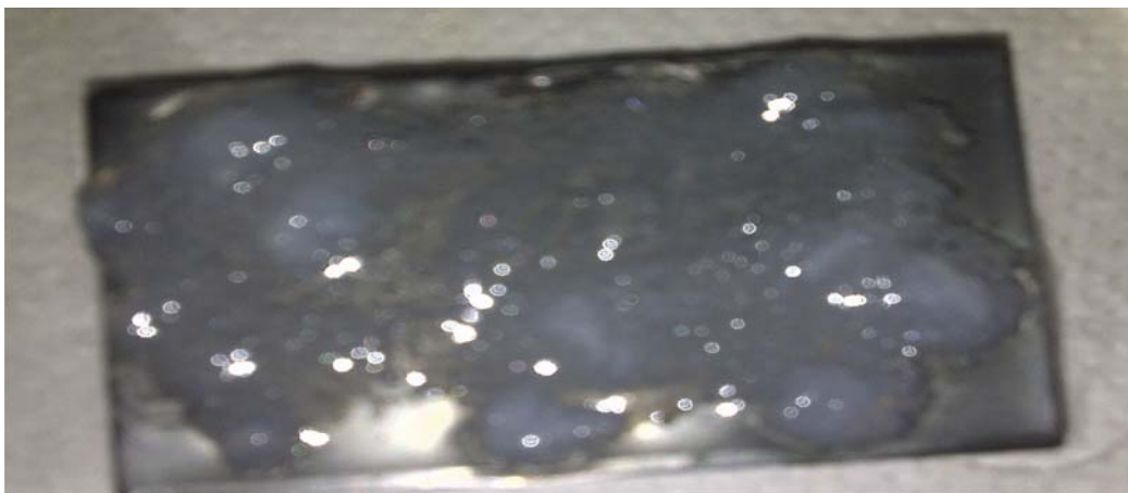
Anexo A.77. Remoción de aceite vegetal con el producto F3 (Fenilsulfonato LAS 50), en la superficie de hierro negro (inicial).
