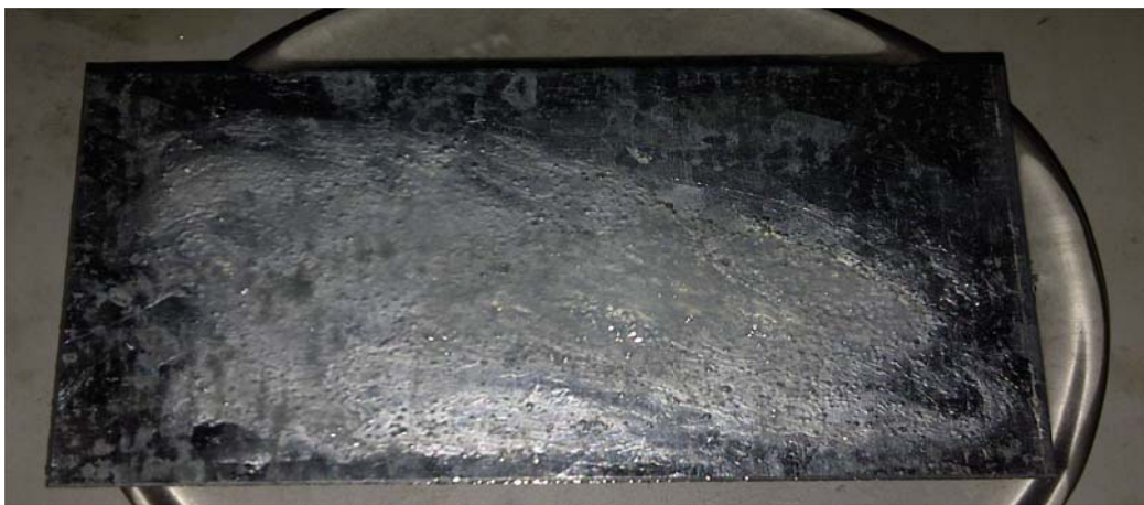
Anexo A.68. Remoción de aceite vegetal reciclado con el producto F3 (Fenilsulfonato LAS 50), en la superficie de hierro galvanizado (inicial).
