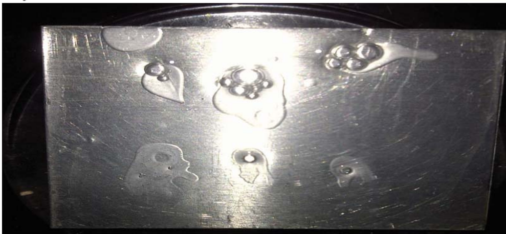
Anexo A.18. Remoción de aceite vegetal con el producto F1 (Genapol BD), en la superficie de aluminio (inicial).
