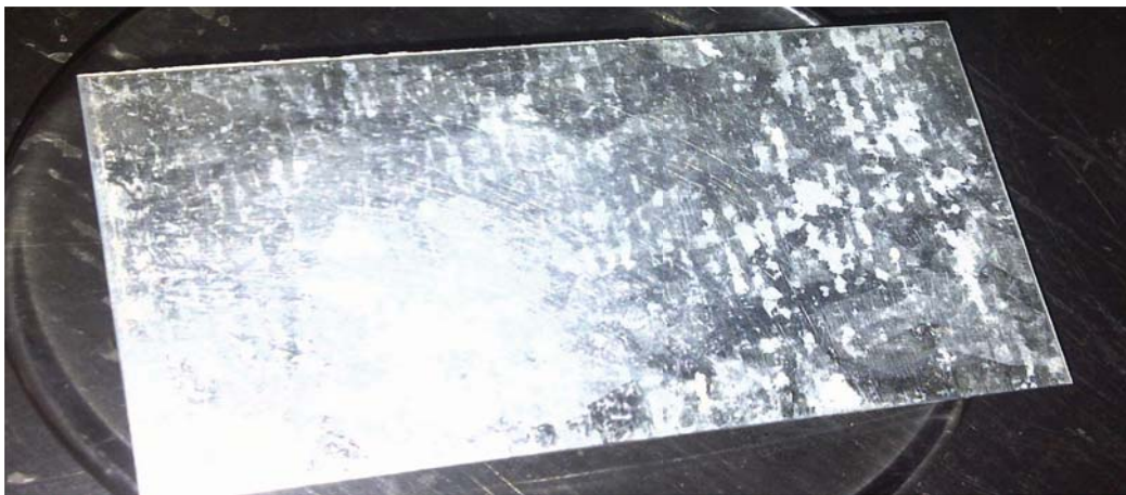
Anexo A.67. Remoción de aceite vegetal con el producto F3 (Fenilsulfonato LAS 50), en la superficie de a hierro galvanizado (final).
