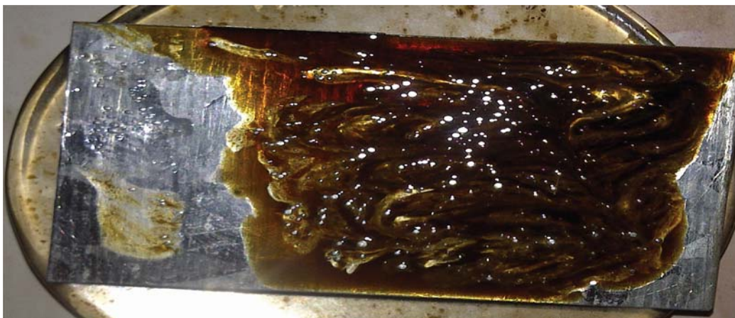
Anexo A.64. Remoción de aceite mineral con el producto F3 (Fenilsulfonato LAS 50), en la superficie de hierro galvanizado (inicial).
