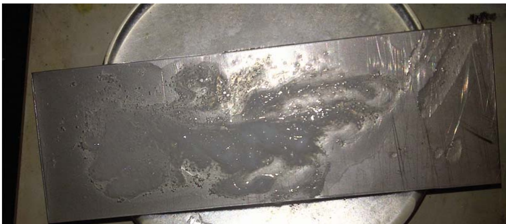
Anexo A.14. Remoción de aceite vegetal reciclado con el producto F3 (Fenilsulfonato LAS 50), en la superficie de acero (inicial).
