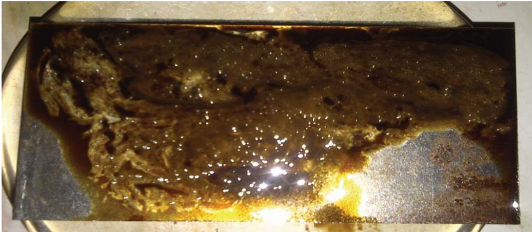
Anexo A.46. Remoción de aceite mineral con el producto F3 (Fenilsulfonato LAS 50), en la superficie de hierro comercial (inicial).
