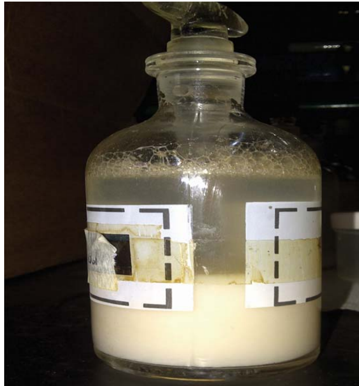
Anexo A.116. Producto F1 (Genapol BD), al 11vo día de estudio, con la adición de sulfato de manganeso y solución de álcali-yoduro-azida.
