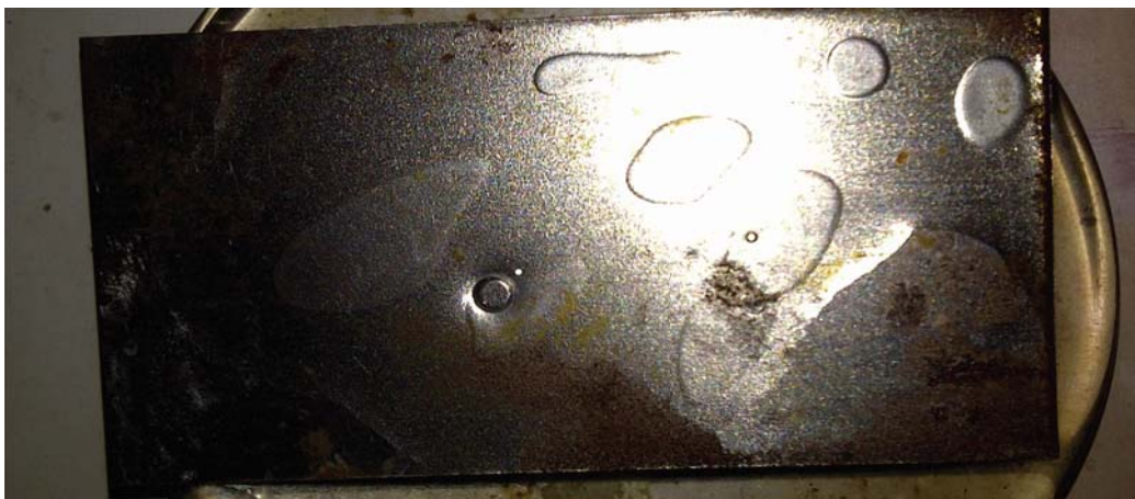
Anexo A.38. Remoción de aceite vegetal reciclado con el producto F1 (Genapol BD), en la superficie de hierro comercial (inicial).
