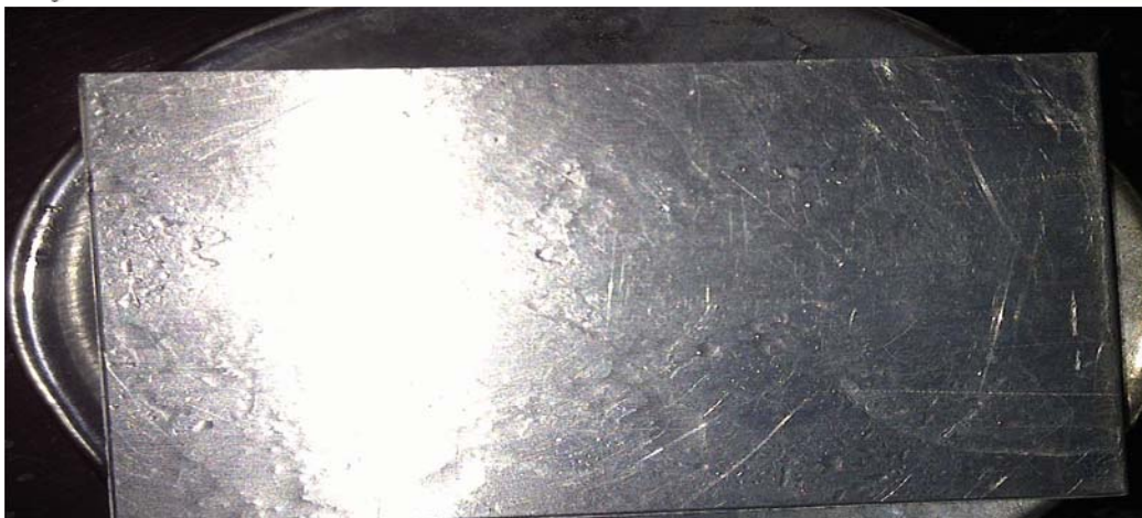
Anexo A.27. Remoción de aceite vegetal reciclado con el producto F2 (Hostapur SAS 60 y Arkopal N 100), en la superficie de aluminio (final).
