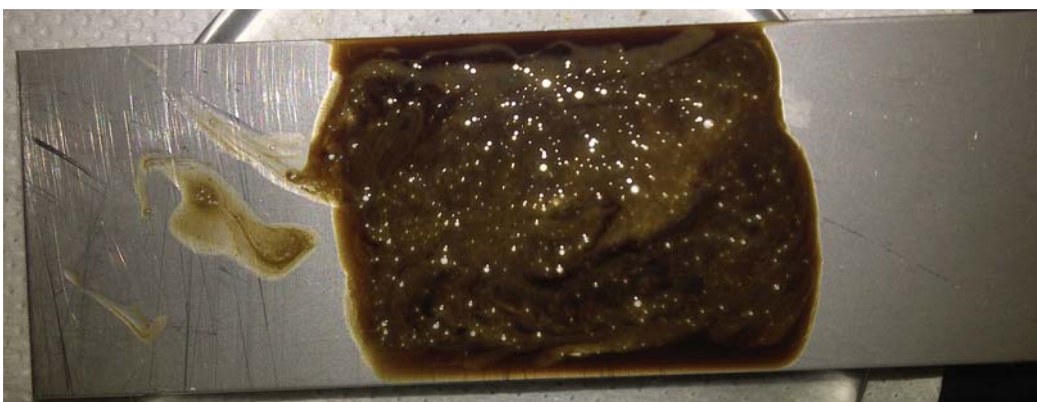
Anexo A.11. Remoción de aceite mineral con el producto F3 (Fenilsulfonato LAS 50), en la superficie de acero.
