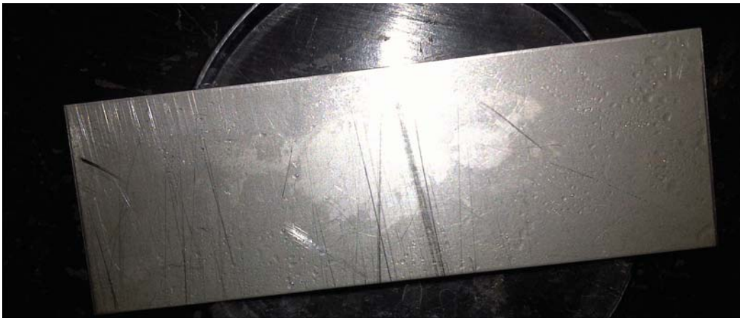
Anexo A.10. Remoción de aceite vegetal reciclado con el producto F2 (Hostapur SAS 60 y Arkopal N 100), en la superficie de acero (final).
