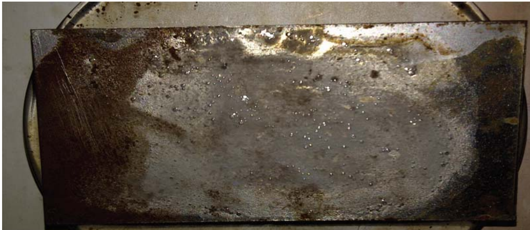
Anexo A.48. Remoción de aceite vegetal con el producto F3 (Fenilsulfonato LAS 50), en la superficie de hierro comercial (inicial).
