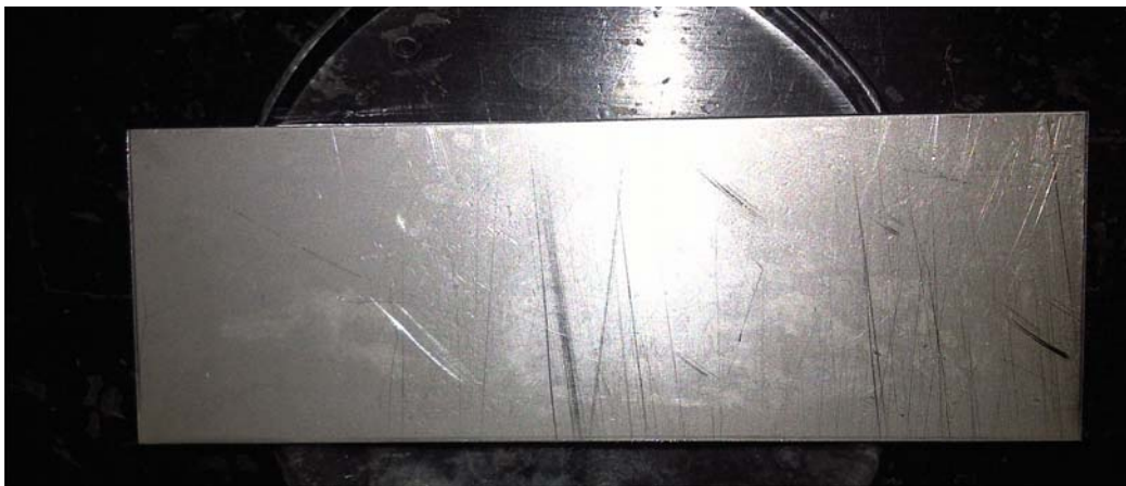
Anexo A.13. Remoción de aceite vegetal con el producto F3 (Fenilsulfonato LAS 50), en la superficie de acero (final).
