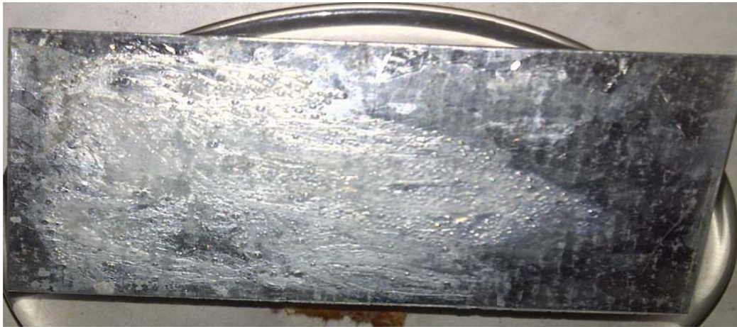
Anexo A.66. Remoción de aceite vegetal con el producto F3 (Fenilsulfonato LAS 50), en la superficie de hierro galvanizado (inicial).
