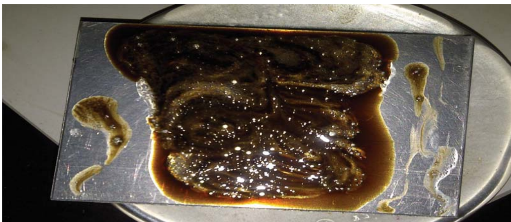
Anexo A.28. Remoción de aceite mineral con el producto F3 (Fenilsulfonato LAS 50), en la superficie de aluminio (inicial).
