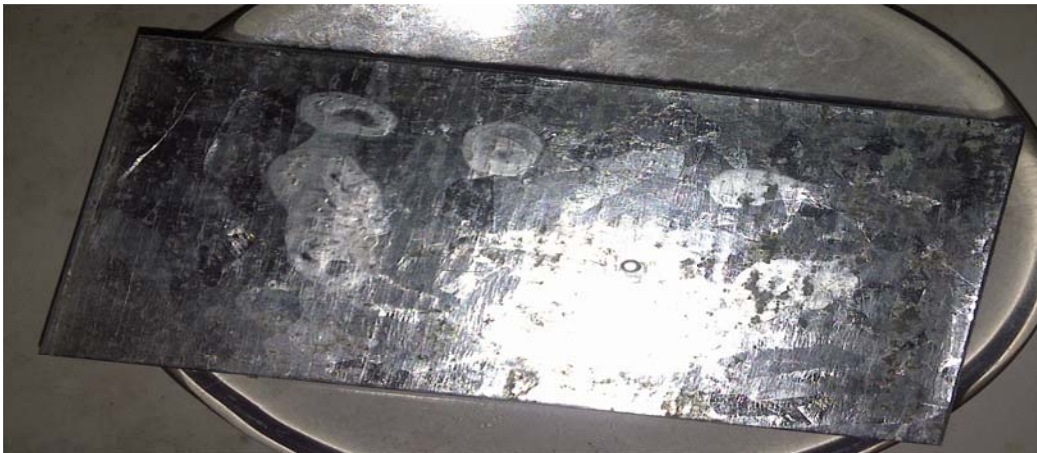
Anexo A.62. Remoción de aceite vegetal reciclado con el producto F2 (Hostapur SAS 60 y Arkopal N 100), en la superficie de hierro galvanizado (inicial).
