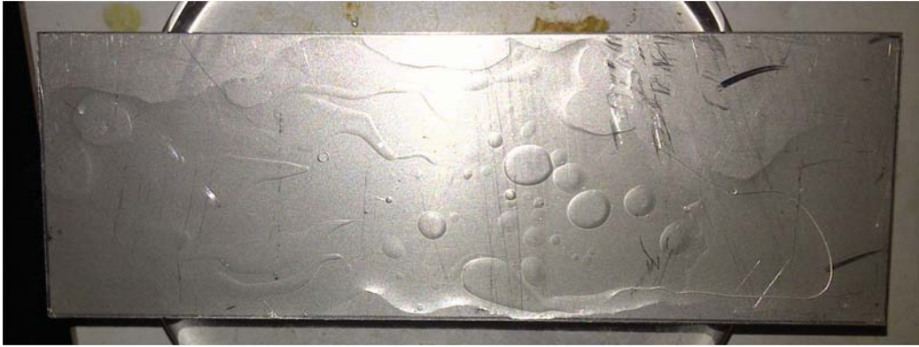
Anexo A.81. Remoción de aceite vegetal con el producto ULTRA CLEAN, en la superficie de acero (inicial).
