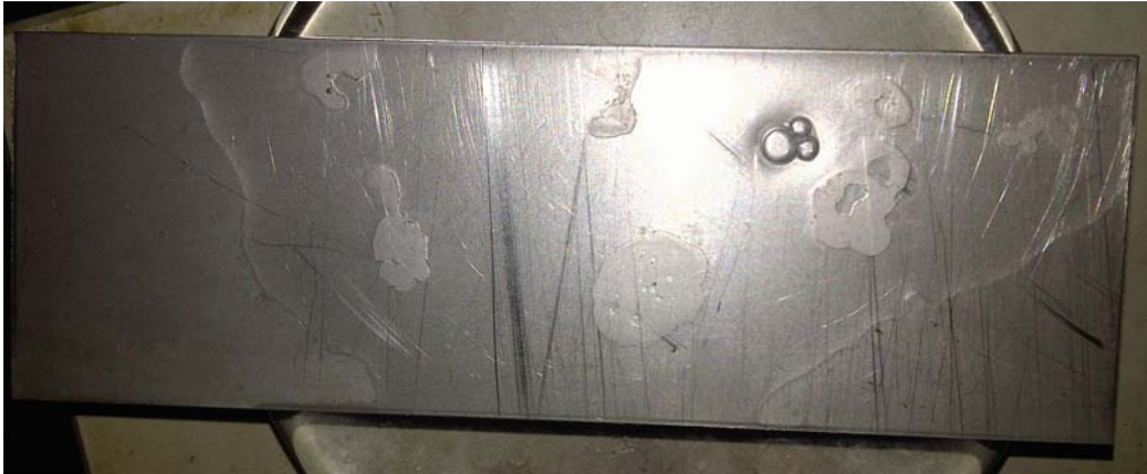
Anexo A.9. Remoción de aceite vegetal reciclado con el producto F2 (Hostapur SAS 60 y Arkopal N 100), en la superficie de acero (inicial).
