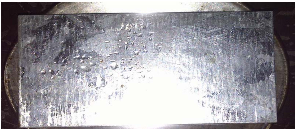
Anexo A.55. Remoción de aceite vegetal con el producto F1 (Genapol BD), en la superficie de hierro galvanizado (final).
