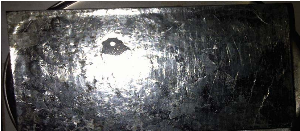
Anexo A.87. Remoción de aceite vegetal con el producto ULTRA CLEAN, en la superficie de hierro galvanizado (inicial).
