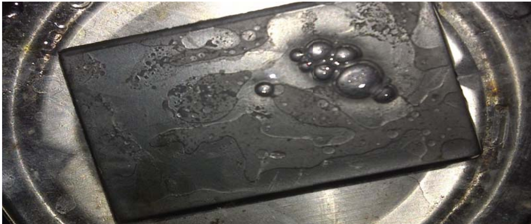
Anexo A.75. Remoción de aceite vegetal reciclado con el producto F2 (Hostapur SAS 60 y Arkopal N 100), en la superficie de hierro negro.
