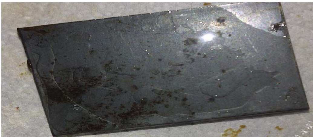
Anexo A.95. Remoción de aceite vegetal reciclado con el producto F1 (Fenilsulfonato LAS 50), en la superficie de hierro negro (inicial).
