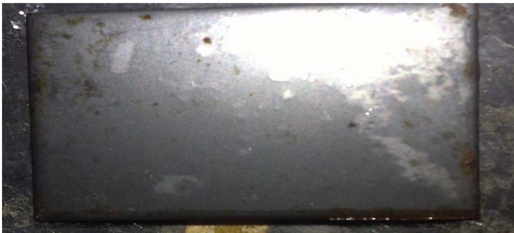
Anexo A.94. Remoción de aceite vegetal con el producto ULTRA CLEAN, en la superficie de hierro negro (final).
