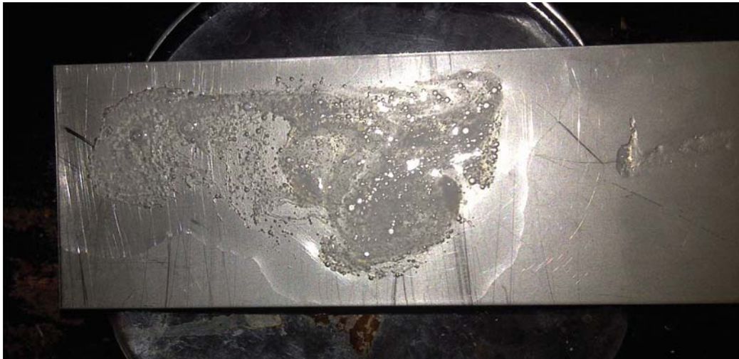
Anexo A.12. Remoción de aceite vegetal con el producto F3 (Fenilsulfonato LAS 50), en la superficie de acero (inicial).
