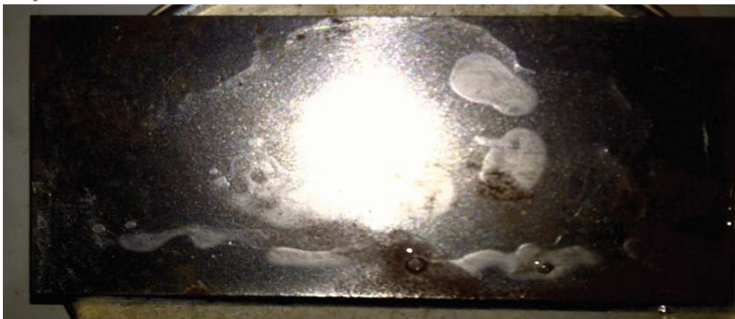
Anexo A.42. Remoción de aceite vegetal con el producto F2 ((Hostapur SAS 60 y Arkopal N 100), en la superficie de hierro comercial (inicial).
