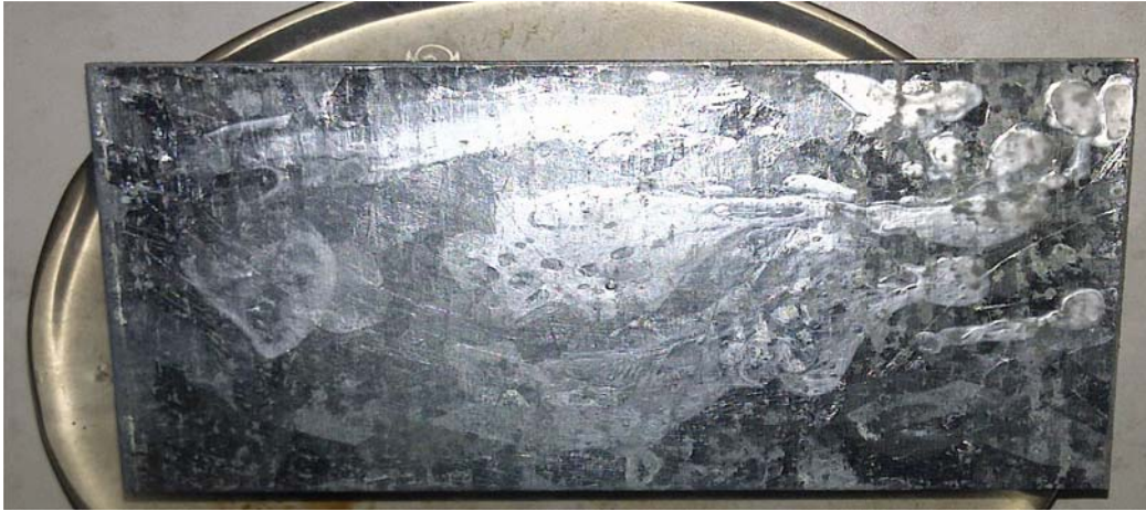
Anexo A.60. Remoción de aceite vegetal con el producto F2 ((Hostapur SAS 60 y Arkopal N 100), en la superficie de hierro galvanizado (inicial).
