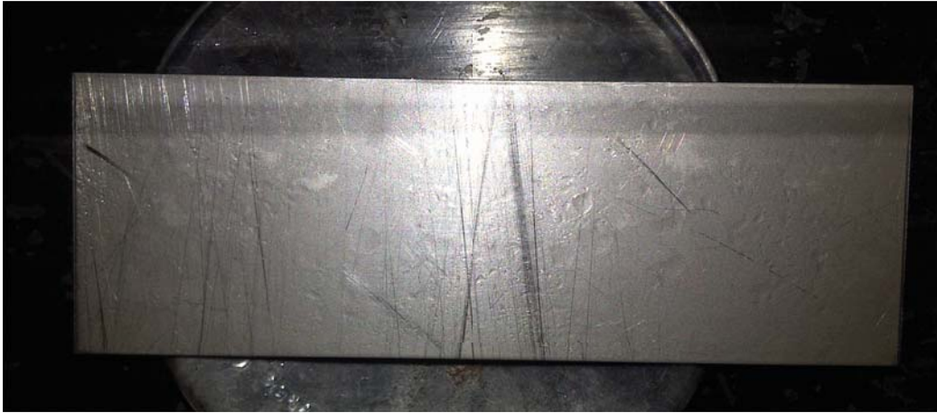
Anexo A.3. Remoción de aceite vegetal reciclado con el producto F1 (Genapol BD), en la superficie de acero acero (final).
