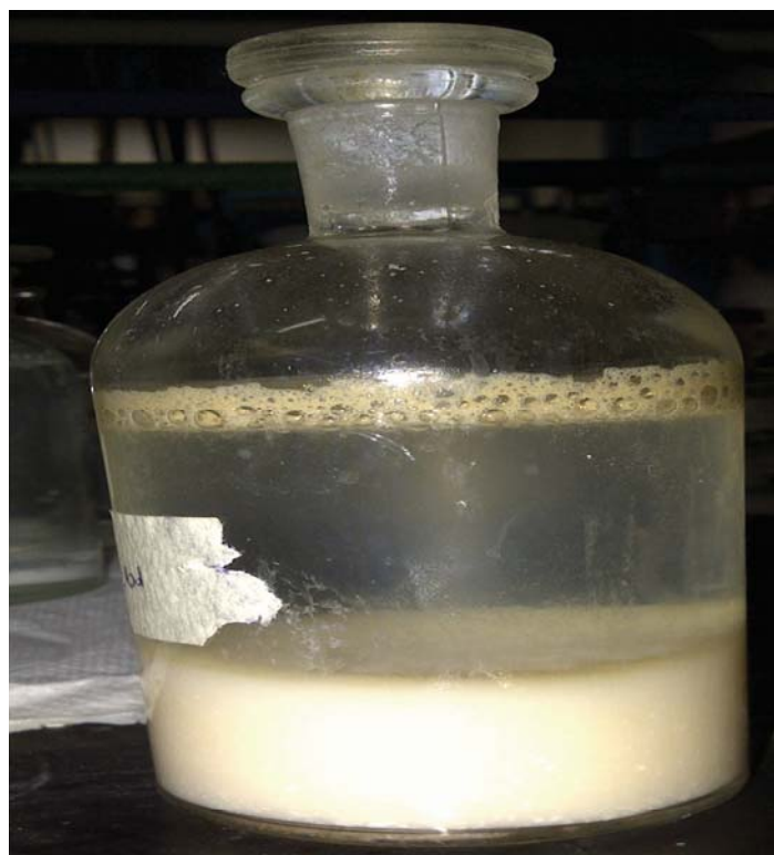
Anexo A.122. Producto F3 (Fenilsulfonato LAS 50), al 11vo día de estudio, con la adición de sulfato de manganeso y solución de álcali-yoduro-azida.
