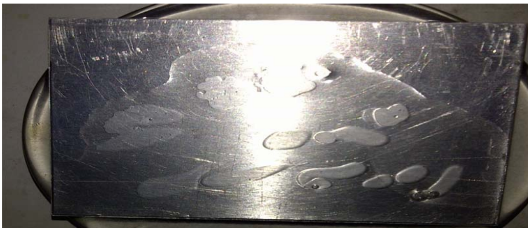
Anexo A.20. Remoción de aceite vegetal reciclado con el producto F1 (Genapol BD), en la superficie de aluminio (inicial).
