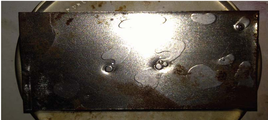
Anexo A.36. Remoción de aceite vegetal con el producto F1 (Genapol BD), en la superficie de hierro comercial (inicial).
