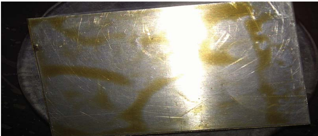
Anexo A.17. Remoción de aceite mineral con el producto F1 (Genapol BD), en la superficie de aluminio (final).
