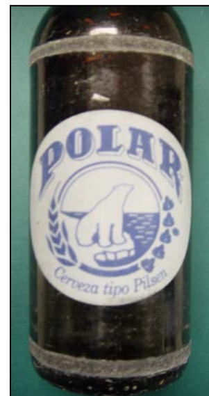
Figura 2.9. Formación de anillos en una botella retornable (Libretti, 2005)
