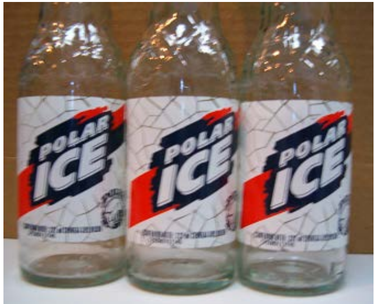
Figura 4.46. Condición de las botellas introducidas en el tren 10 después de 8 vueltas una vez realizados los ajustes
