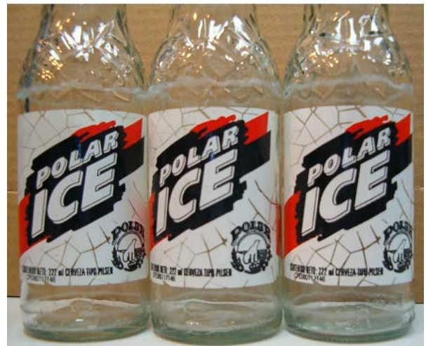
Figura 4.34. Condición de las botellas introducidas en el tren 8 después de 10 vueltas antes de los ajustes
