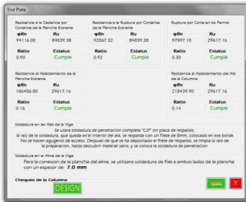
Figura LXXVIII. Ventana de resultados de conexión end plate.
