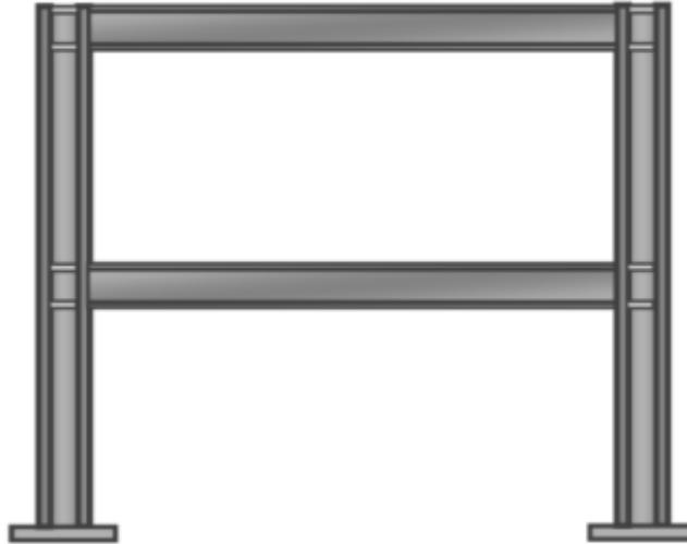
*Figura X. Pórtico resistente a momento.*
