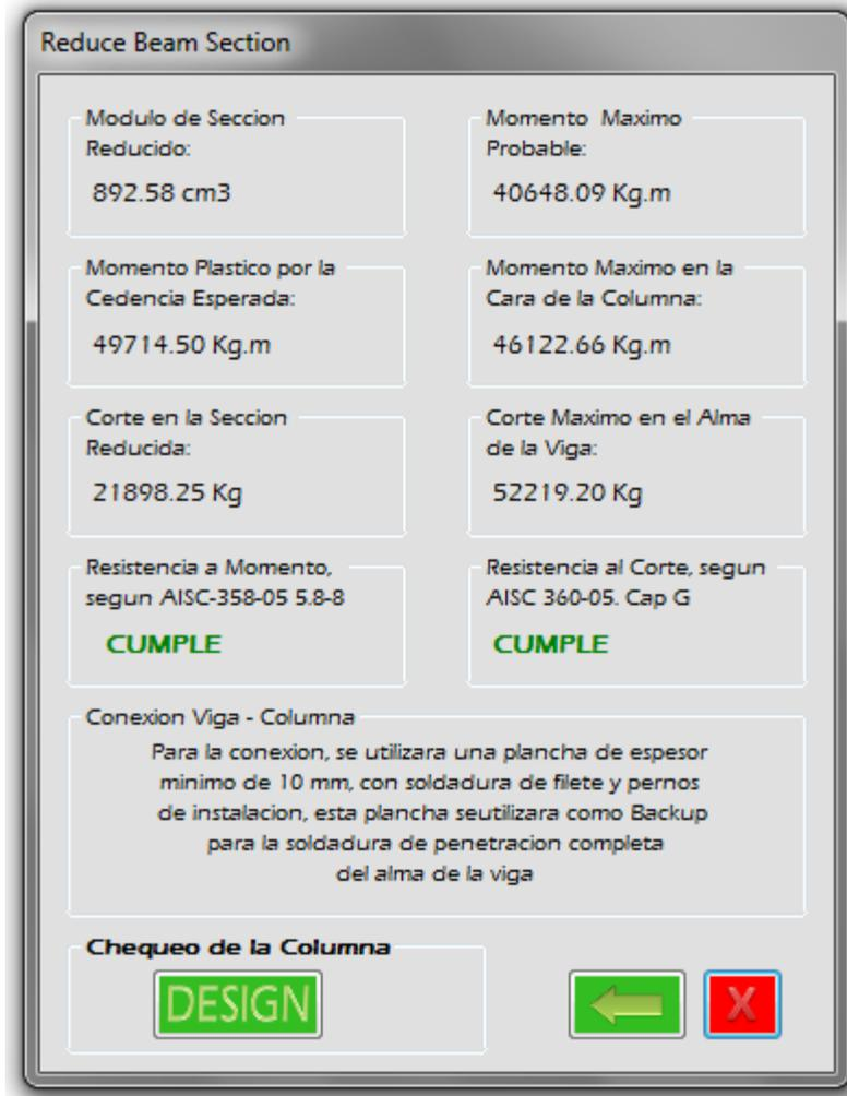
Figura LXXXVI. Conexión a momento, reduce beam section, resultados.
