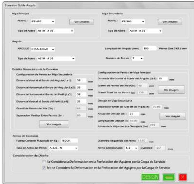
*Figura LXXXI. Conexión a corte, doble ángulo, datos.*
