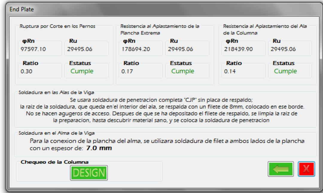
Figura XCV. Conexión a momento, end plate 4ES, resultados.
