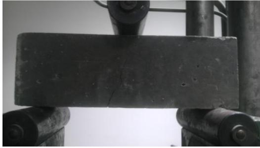
Ensayo a flexión de las viguetas.
