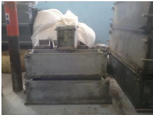
Moldes para las viguetas de concreto.
