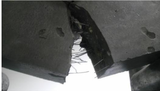
Sección de falla de una vigueta dosificada con fibra.
