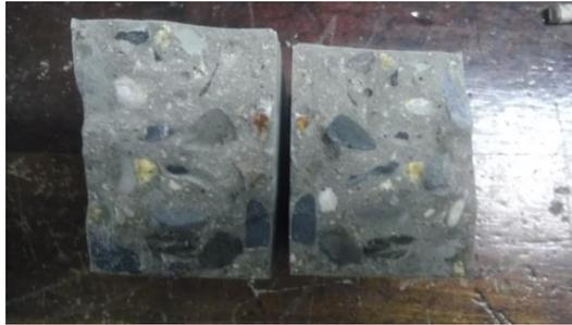
Sección de falla de una vigueta sin dosificación de fibra.
