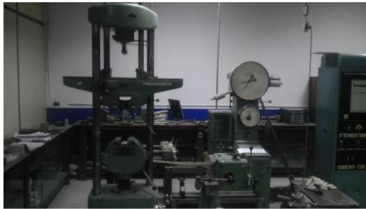
Máquina usada para realizar ensayos a flexión a las viguetas.
