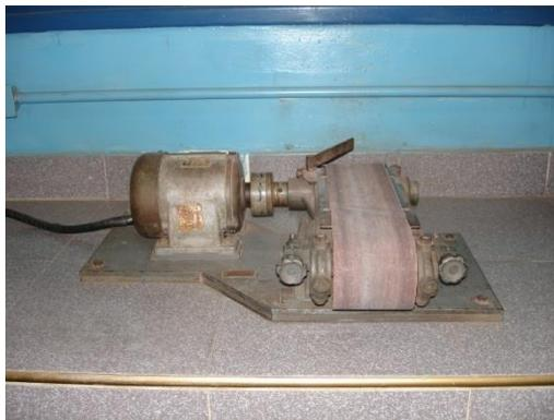
**Figura 3.5** Lijadora de Banda.
