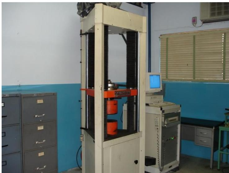
**Figura 3.3** Maquina ensayo tracción Galdabini
