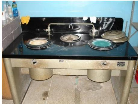
**Figura 3.7** Pulidora metalográfica.
