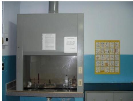
**Figura 3.8** Campana extractora de gases químicos.
