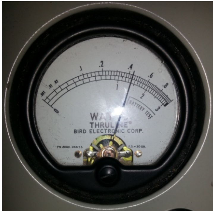
Figura 4.25: Potencia máxima de salida a 104,5 MHz: 14 W.
