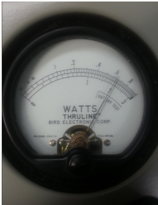
Figura 4.17: Potencia máxima de salida a 104,5 MHz: 20 W.
