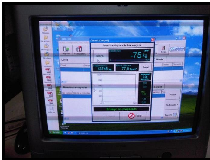
Figura 14. Monitor de resultados de la maquina para ensayo a compresión. Nota. Fuente: Propia
