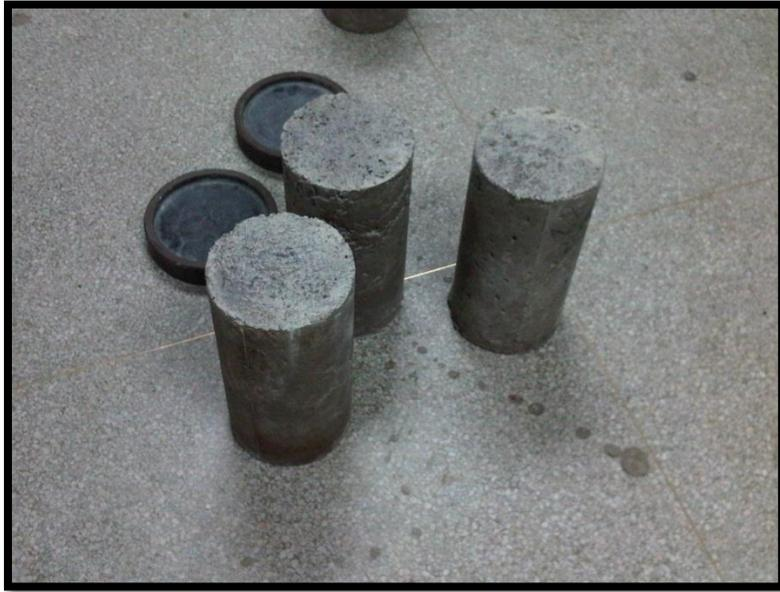
Figura 25. **Cilindros húmedos al momento de la Rotura.** *Nota.* Fuente Propia.
