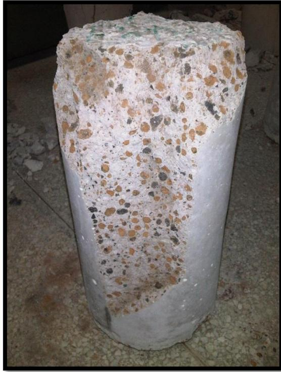
**Figura 27. Cilindro fracturado luego de haberse secado, como debería haber estado luego de la rotura. Nota.** Fuente Propia.
