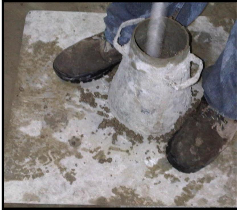
Figura 24. **Medición de la trabajabilidad con el cono de Abrams.** *Nota.* Fuente Propia.
