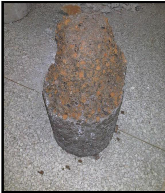
Figura 26. **Cilindro fracturado con presencia de humedad del núcleo.** *Nota.* Fuente Propia.
