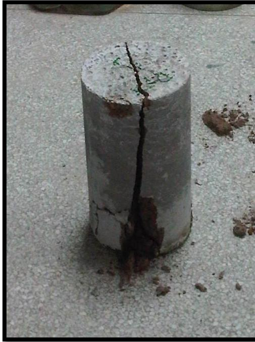
Figura 28. **Falla del cilindro luego de haber aplicado la carga.** *Nota.* Fuente Propia.
