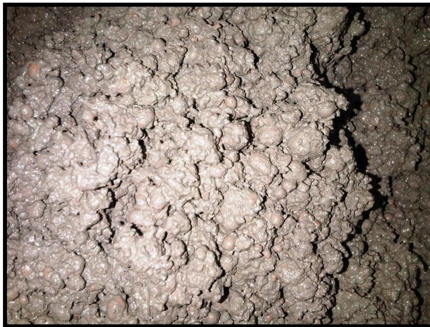
**Figura 23. Mezcla realizada con ALIVEN® FINO sin saturación adecuada.**
