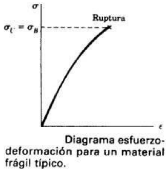
Figura 4: Diagrama esfuerzo – deformación para un material frágil típico.
