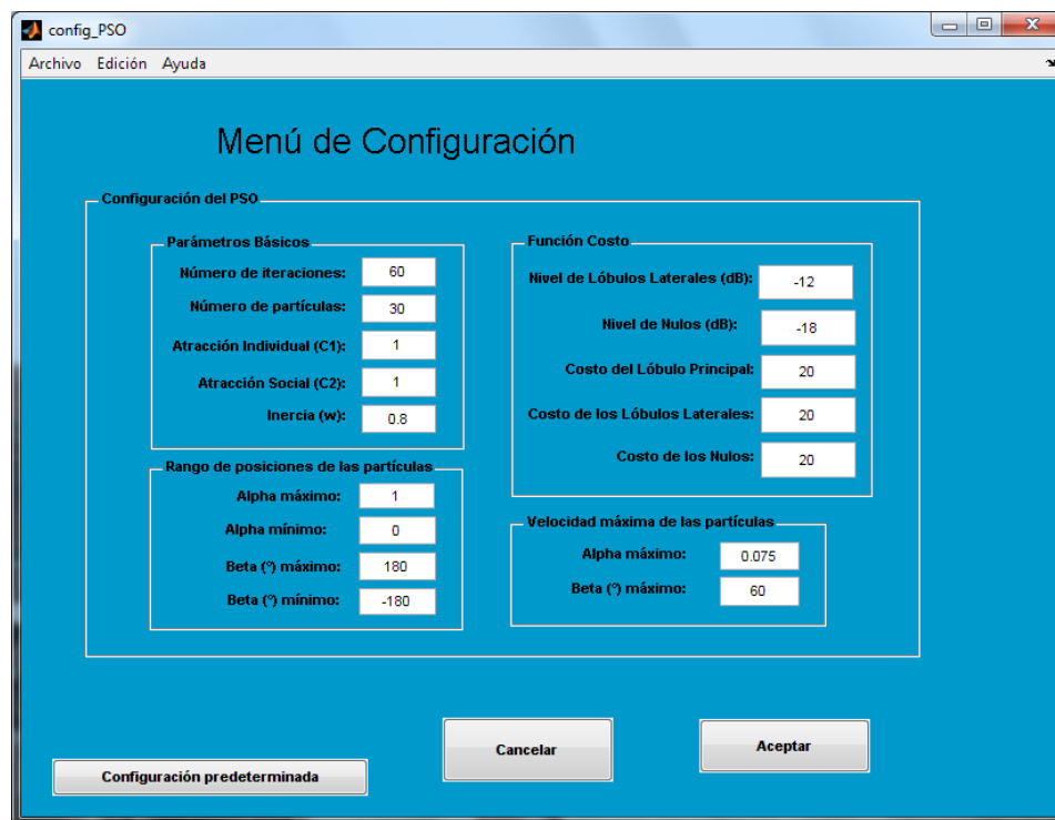
Figura 4.74: Configuración de la función costo siendo el costo de los nulos de radiación mayor.
