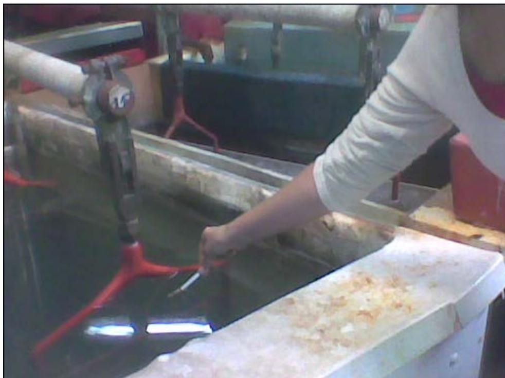
Figura C.5. Medición del pH usando papel indicador
