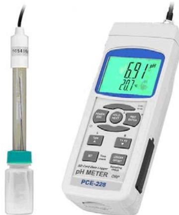
Figura 4.20. Equipo de medición de pH tipo 1
