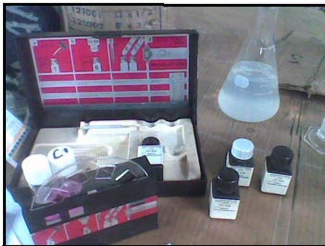
Figura 3.3. Fotografía del kit colorimétrico portátil de la empresa.
