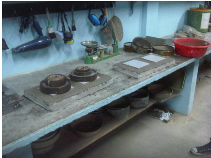
Colocación de pesas 5Kg según COVENIN
