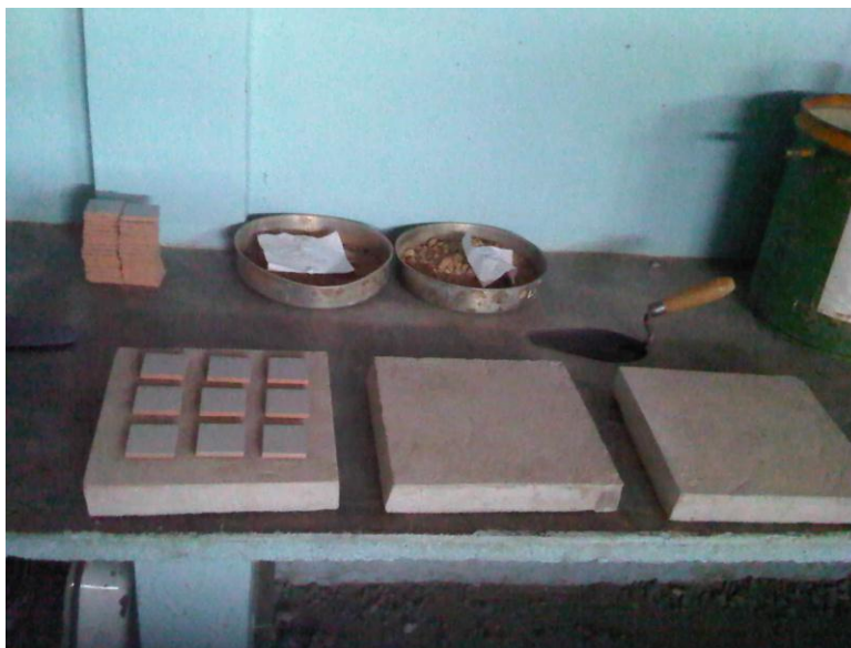
Placas de concreto y muestra de ubicación de probetas
