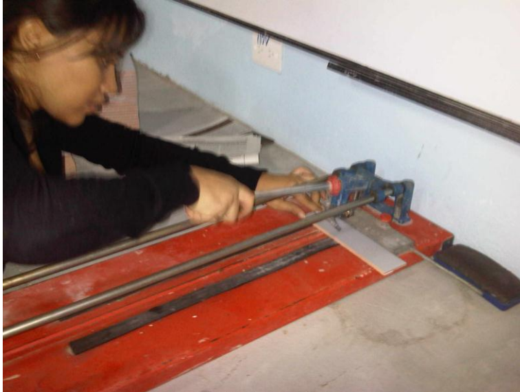
Cortando probetas para el ensayo de adherencia (50 x 50) mm
