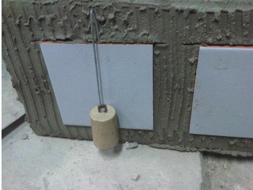
Colocación de pesa sobre probeta para medir deslizamiento
