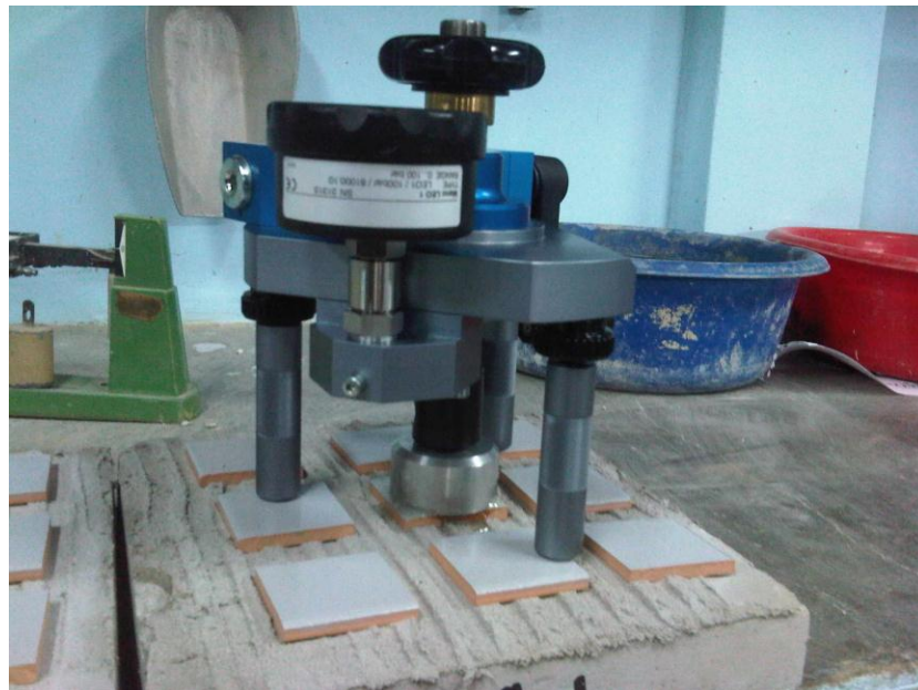
Maquina de tracción lista para realizar ensayo
