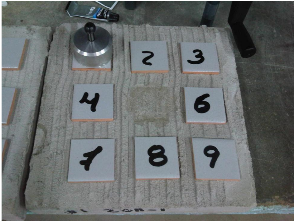
Muestra de placa con probeta ya arrancada
