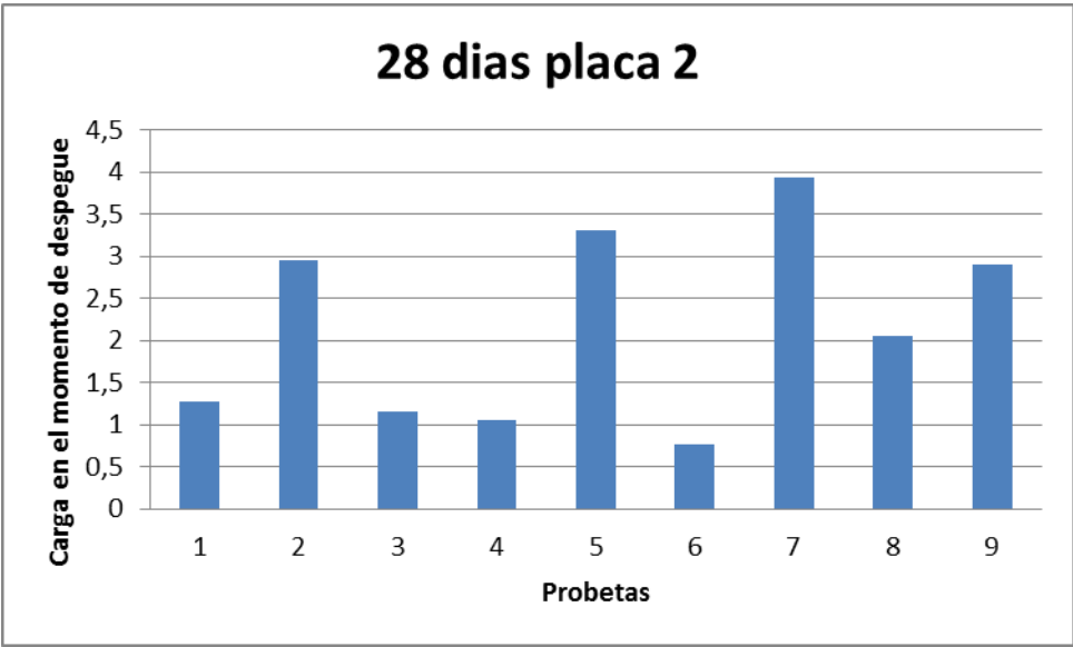
Grafica 6. Comportamiento de las probetas a la hora de despegue Muestra B
