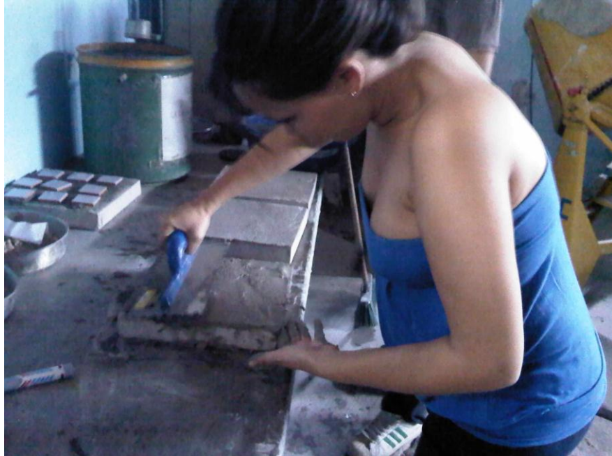
Pasando llana dentada según norma a placa de concreto
