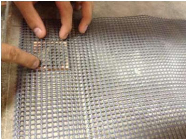
**Figura 27. Colocación de Probetas 3 y 4 para el ensayo de Tiempo Abierto.** *Nota.* Datos tomados de Isoldi (2012)
