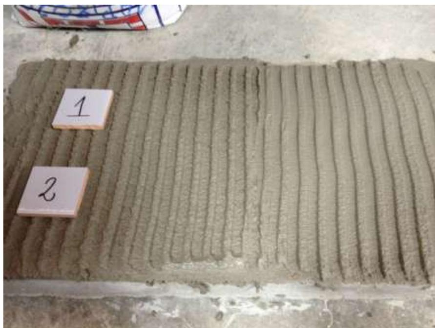
**Figura 24. Colocación de pesas de 2 Kg. para el ensayo de Tiempo Abierto.** Nota. Datos tomados de Isoldi (2012)
