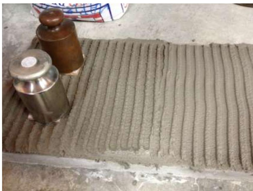
**Figura 26. Medición de mortero remanente en la probeta con la malla para determinar el Tiempo Abierto.** *Nota.* Datos tomados de Isoldi (2012)
