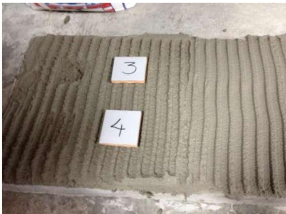
**Figura 28. Colocación de pesas de 2 Kilos en las probetas 3 y 4 para el ensayo de Tiempo Abierto. Nota. Datos tomados de Isoldi (2012)**
