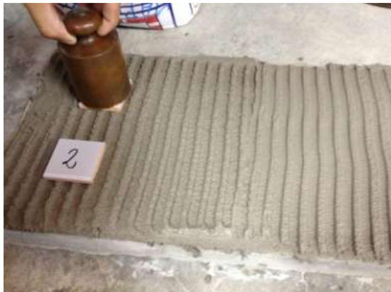
**Figura 25. Colocación de pesas de 2 Kg. para el ensayo de Tiempo Abierto.** Nota. Datos tomados de Isoldi (2012)
