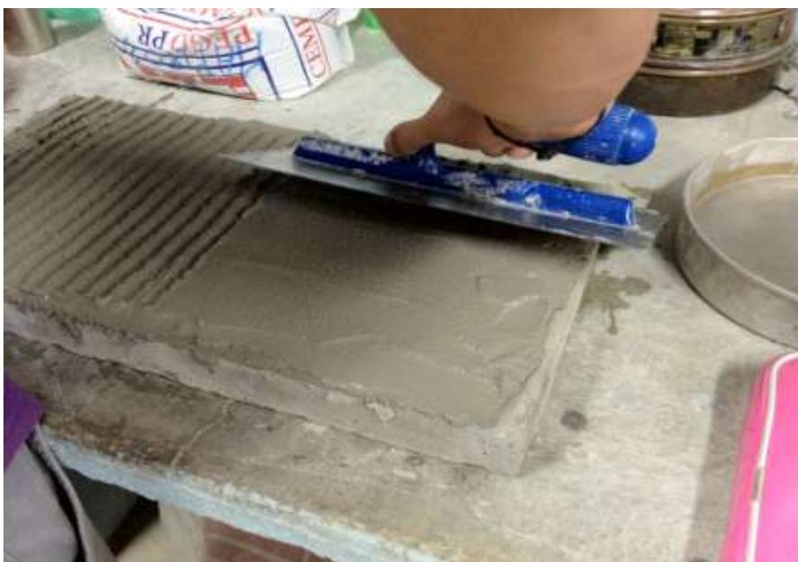
**Figura 23. Colocación de Probetas 1 y 2 para el ensayo de Tiempo Abierto.** *Nota.* Datos tomados de Isoldi (2012)
