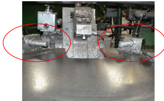
FIGURA 4.43 GUÍAS FINALES DE LOS POSICIONADORES DEL ARO EN EL MÁQUINA PUNZONADORA
