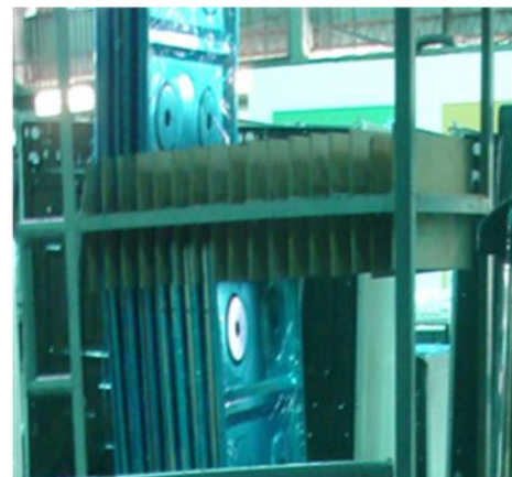
Figura N° II.16. Dispositivo porta Cubierta de Cocina.
