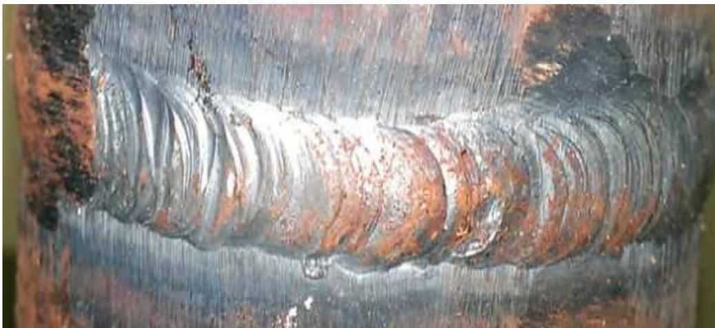
**Figura 4.2** Fotografía del cordón exterior de la probeta con combinación 100 A – 0,566 m<sup>3</sup>/h
