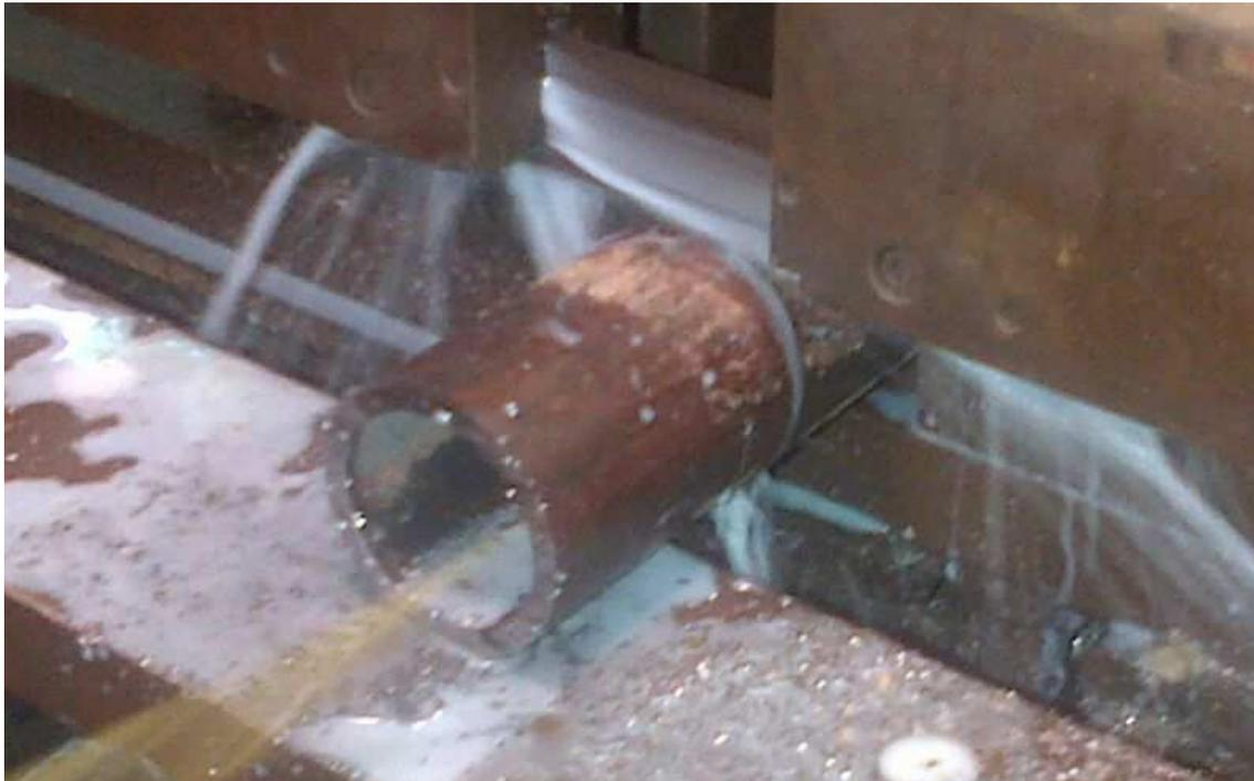
**Figura 3.1** Corte de las probetas de estudio. Acero SA 106 Gr. B
