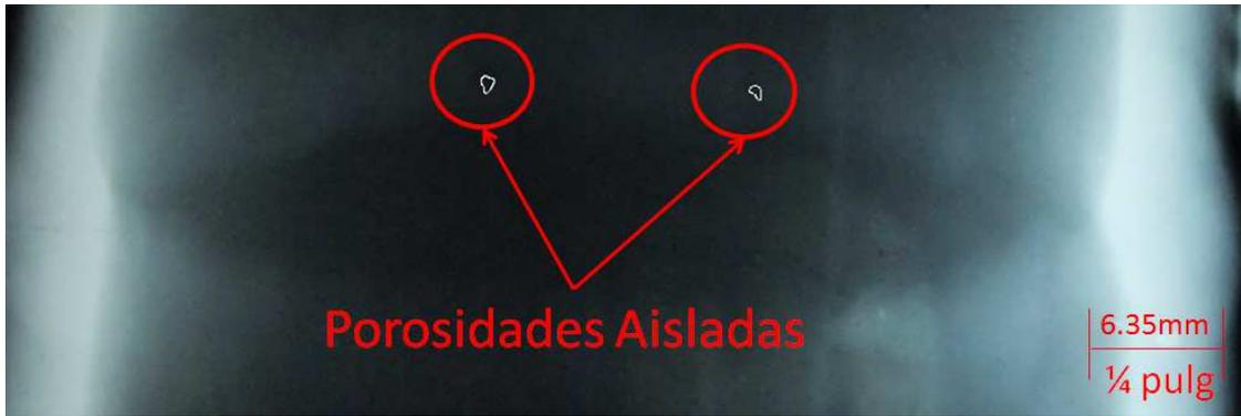
**Figura 4.4** Fotografía de la radiografía la probeta con combinación 100 A y 0,566 m<sup>3</sup>/h
