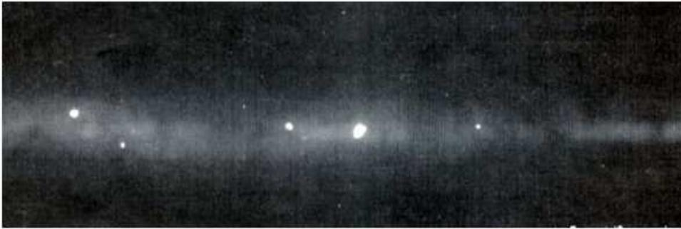
**Figura 2.16.** Inclusión de tungsteno en soldadura. (López Galvez & Orozco Roldan, 2013)
