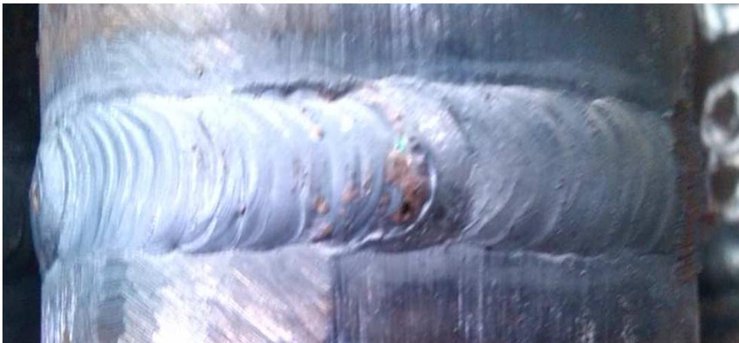
**Figura 4.1** Fotografía del cordón exterior de la probeta con combinación 80 A – 0,283 m<sup>3</sup>/h
