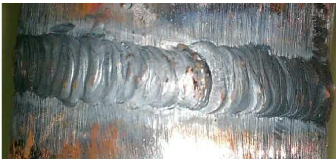
**Figura 4.3** Fotografía del cordón exterior de la probeta con combinación 120 A – 0,850 m<sup>3</sup>/h
