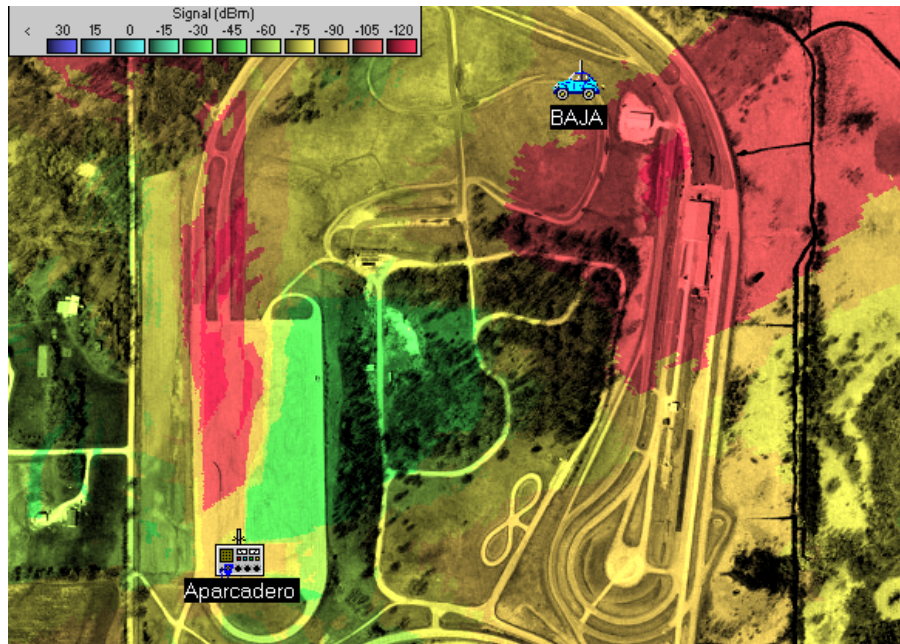
Figura a.1: Mapa de cobertura del receptor (PC) de la primera simulación para la pista 1.
