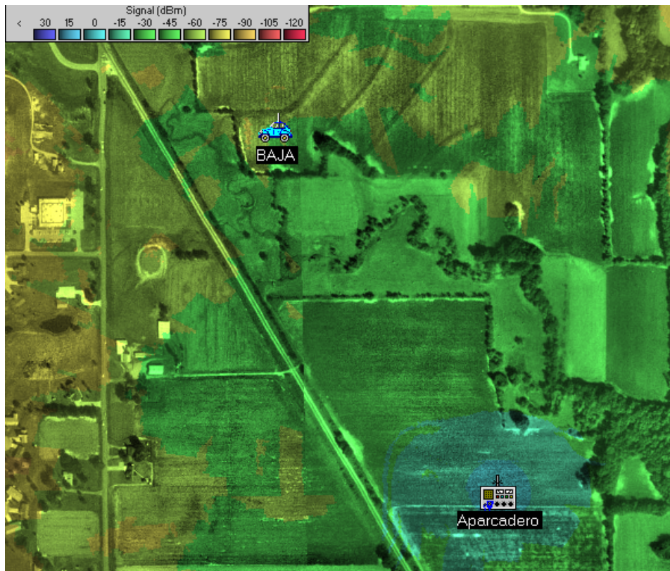
Figura 4.27: Mapa de cobertura del receptor (PC) de la simulación para la pista 2.
