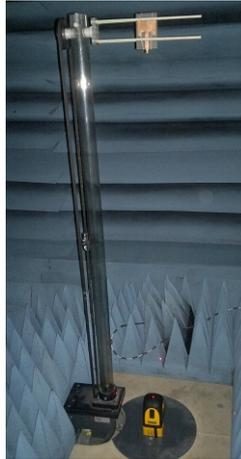
**Figura 3.16:** Alineación de la antena bajo medición (A1) usando teodolito (instrumento amarillo con negro) - medición de parámetro  $S_{21}$
