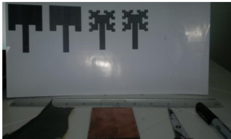
Figura 3.7: Protección de la Forma - Lija delgada, trozo de sustrato, tijera y marcador permanente
