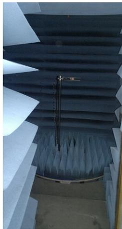
**Figura 3.17:** Equipo rotatorio dentro de la cámara anecoica con absorbentes de carbono (pirámides azules y soporte negro) - medición de parámetro  $S_{21}$
