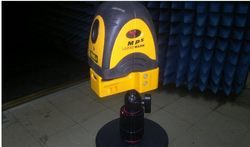
**Figura 3.18:** Teodolito - instrumento usado para alineación de antena bajo medición (A1) y antena patrón (AP) con antena receptora (B2) - medición de parámetro  $S_{21}$
