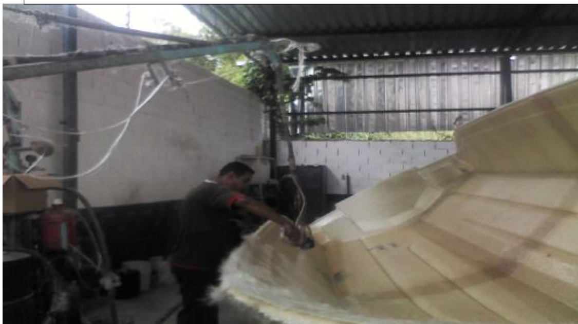
Fotografía N° 4. Taller de Elaboración de Lanchas, manipulación de sustancias tóxicas en aerosol sin protección nasal.
