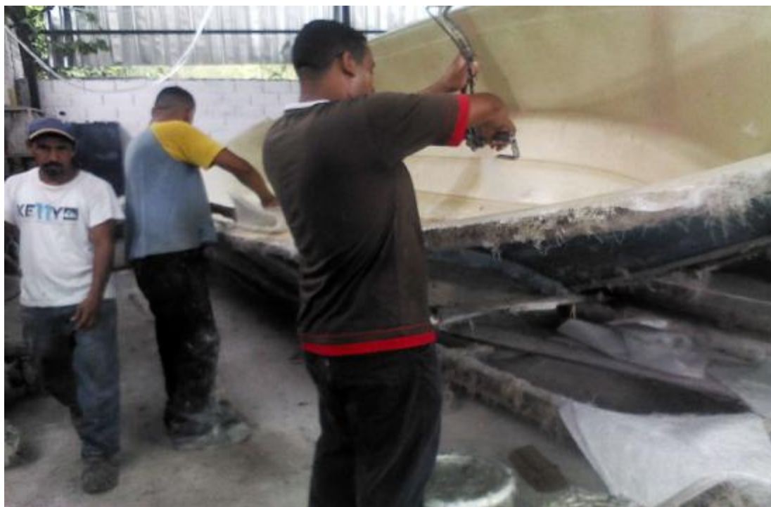
Fotografía N° 3. Taller de Elaboración de Lanchas, manipulación de sustancias tóxicas sin la protección adecuada.
