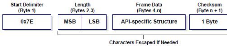
Figura 2.2: Estructura de la trama de datos UART con AP=2. [1]
