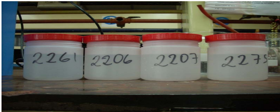
Figura 4.3. Coagulantes preparados para la prueba de jarras.
