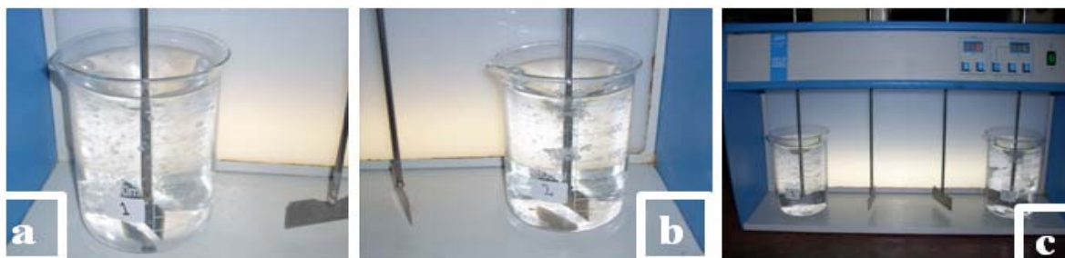
Figura 4.2. Preparación de los polímeros. a) Arpol 2298 durante la agitación; b) Arpol 2209 durante la agitación; c) Etapa de maduración de los polímeros.
