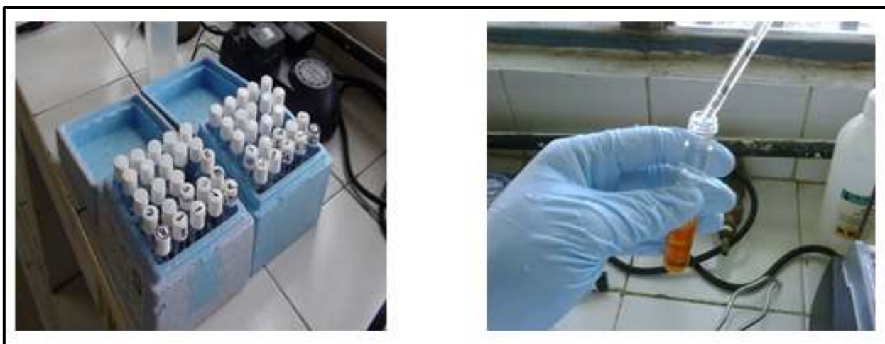
Figura 3.9. Preparación de muestras y blancos a digerir en el reactor DRB200.
