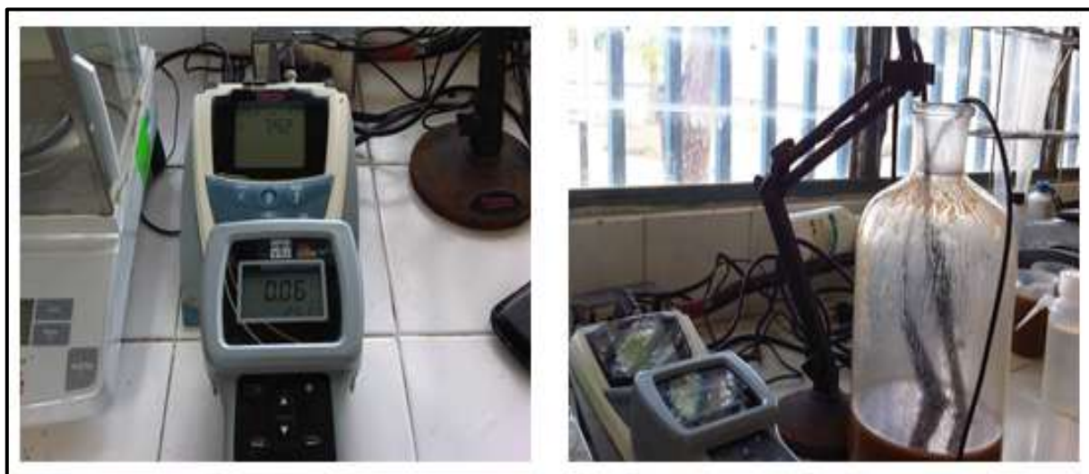
Figura 3.14 Medición conjunta de OD, pH y temperatura.
