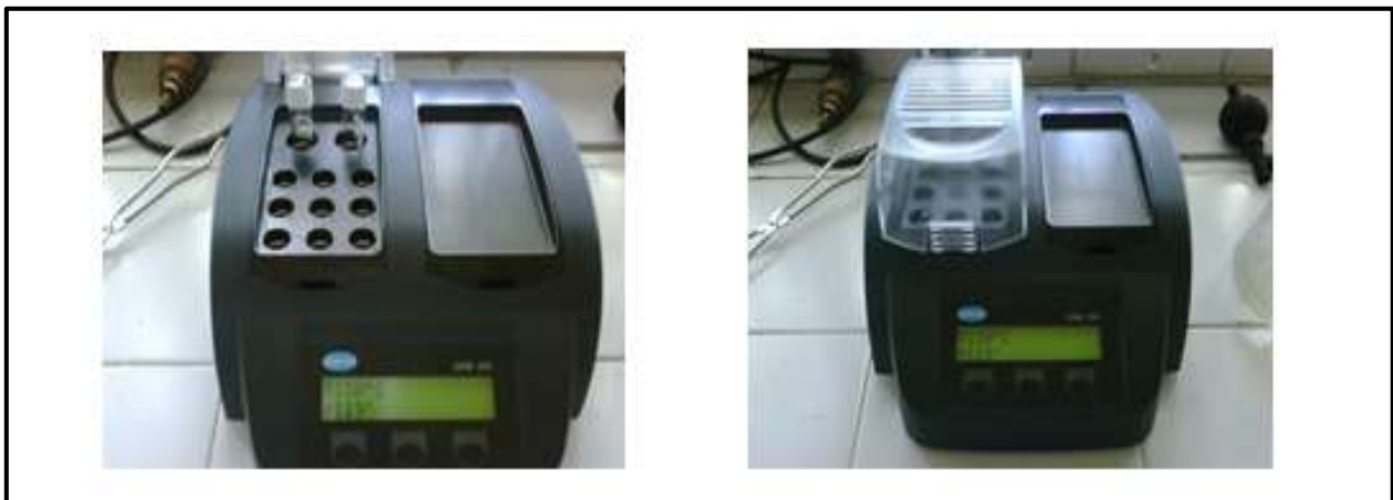
Figura 3.10. Digestión de la muestra y blanco por 2 horas.
