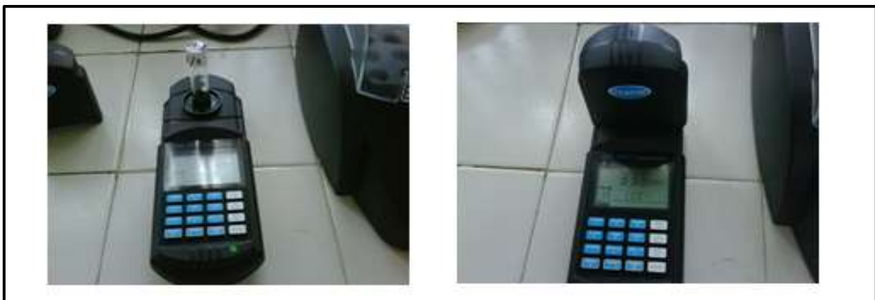
Figura 3.11. Medición de DQO con el colorímetro DR890 Hach.
