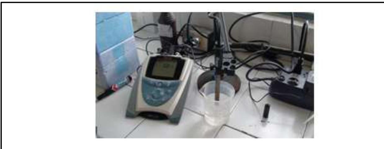
Figura 3.12. Medición de pH de una muestra individual P-1.
