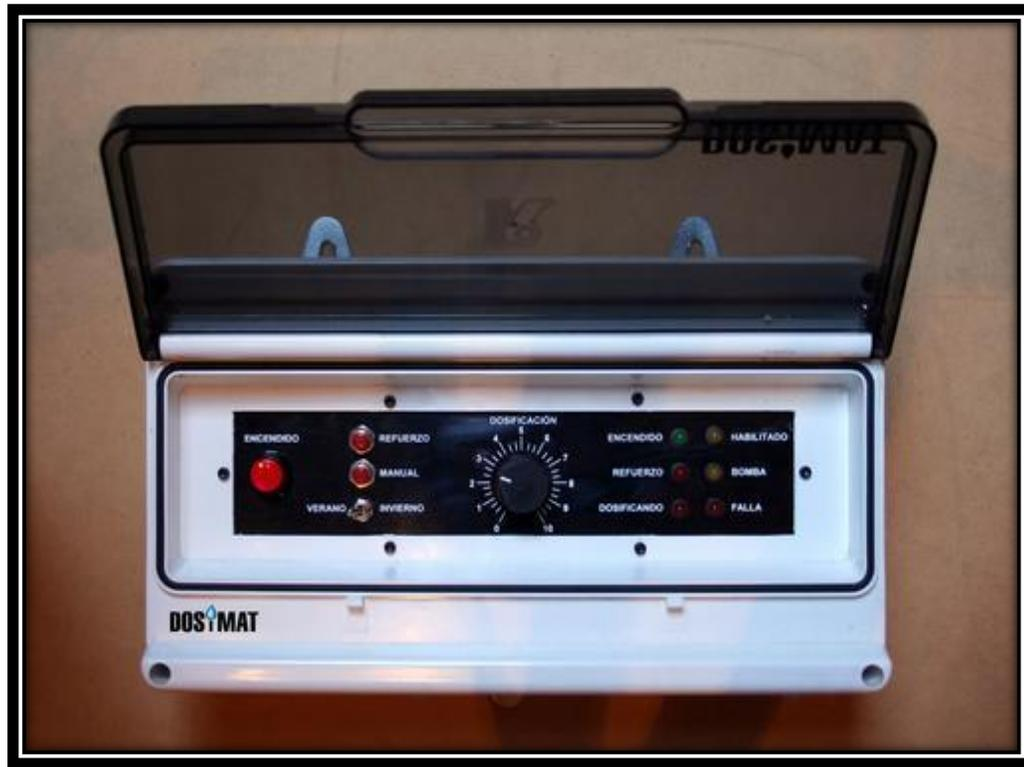
Fig.27 Equipo dosificador de cloro
