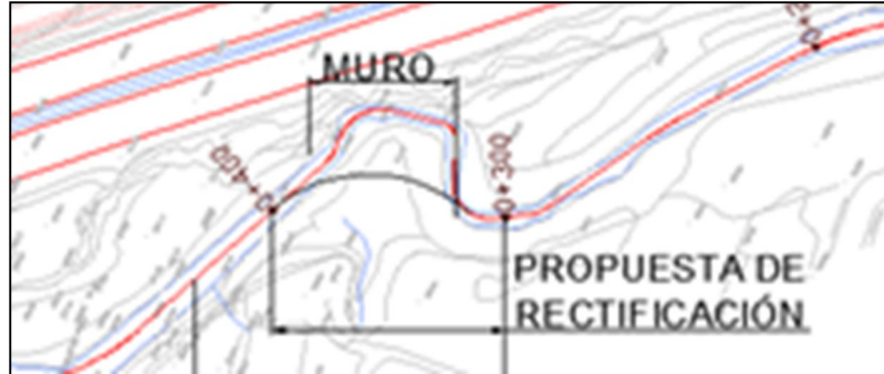
Figura 29. Ubicación en planta del muro de contención y la propuesta de rectificación. Nota. Elaboración de los autores.
