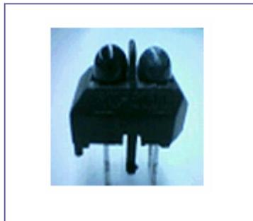
**Figura 2.18 Sensor fotoeléctrico utilizado**
