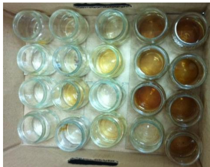
Figura 14. Alícuotas de cada una de las fracciones EXT, AH, AF, SNH previas a la evaporación.
