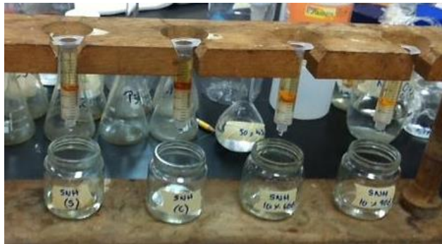
Figura 12. Separación de ácidos fúlvicos y sustancias no húmicas en las muestras tratadas, por medio de una columna de PVP.
