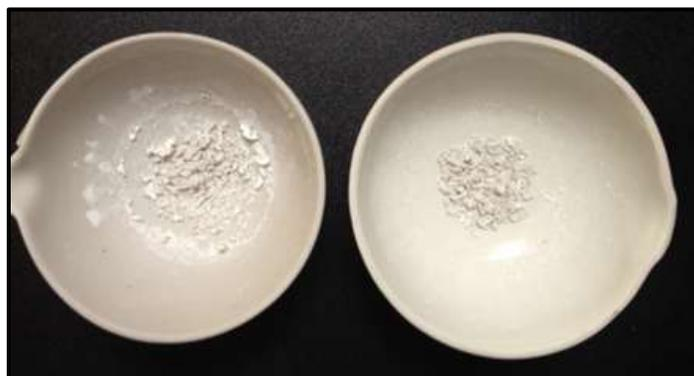
**Figura 3.25** Nanopartículas de sílice calcinadas: producto final de la síntesis de reacción sol- gel asistido por una emulsión agua en aceite (w/o) sistema Do, sometido a calcinación en una mufla a 600°C durante 3 horas con una tasa promedio de aumento de temperatura de 10 °C/min.
