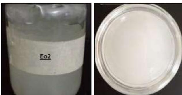
**Figura 4.46** Producto final de la síntesis de reacción sol- gel: asistido por una emulsión agua en aceite (w/o) y utilizando tetraortosilicato como precursor en medio básico. Sistema Eo2.
