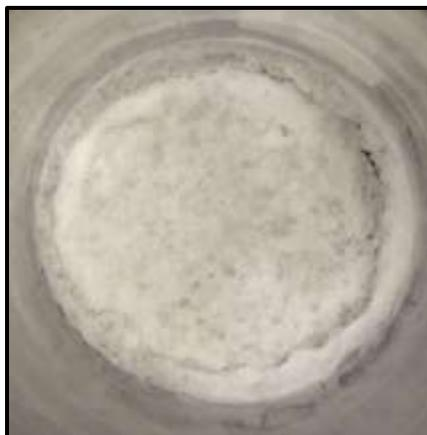
**Figura 3.24** Producto final de la síntesis de reacción sol- gel asistido por una emulsión agua en aceite (w/o) sistema Do, sometido a un proceso de vaporización a 50°C durante 6 horas.
