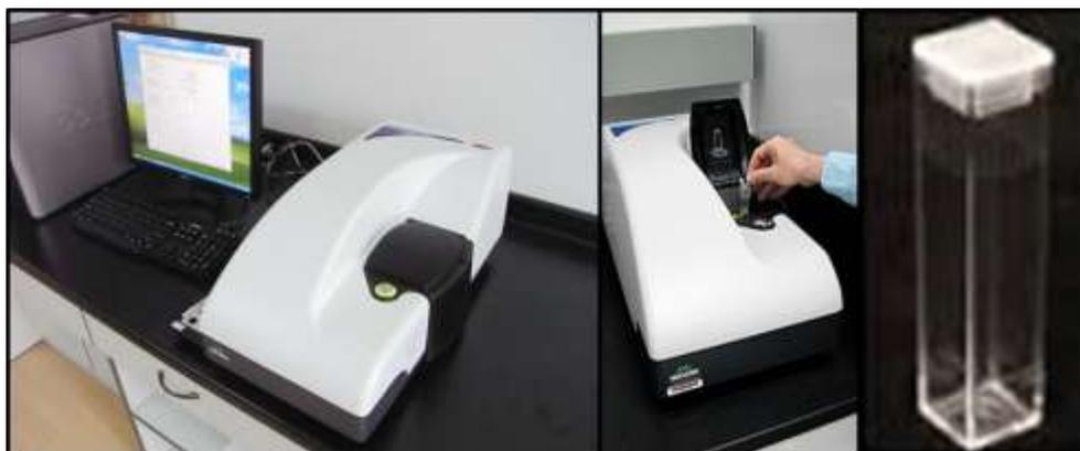
**Figura 3.19** Analizador de tamaño de partícula o tamaño de gota por difracción de luz dinámica. Equipo zetasizer nano modelo: ZS90 marca: malvern. Disponible en las instalaciones de Intequin
