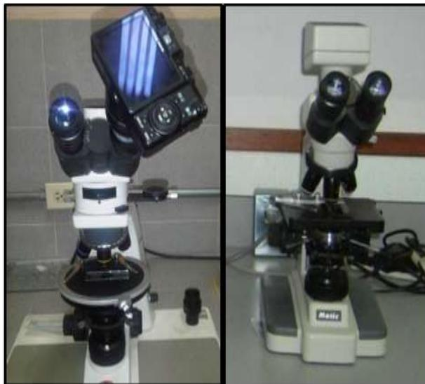
**Figura 3.21** Microscopio óptico conectado al computador para obtener la imagen digital. Ubicado en el laboratorio de instrumentación, materiales, caracterización y óptica. FACYT – Física. Universidad de Carabobo.
