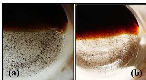
Figura 11. Etoxiquina precipitada en n-heptano (a) y en aceite mineral (b).
