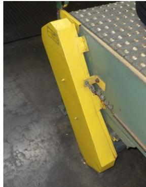
Imagen # 4. Ejemplo de protección 360° de partes móviles.
