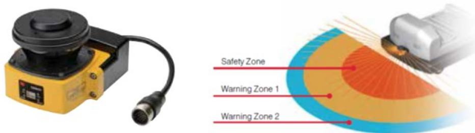
Imagen # 6. Ejemplo de escáner de presencia laser.
