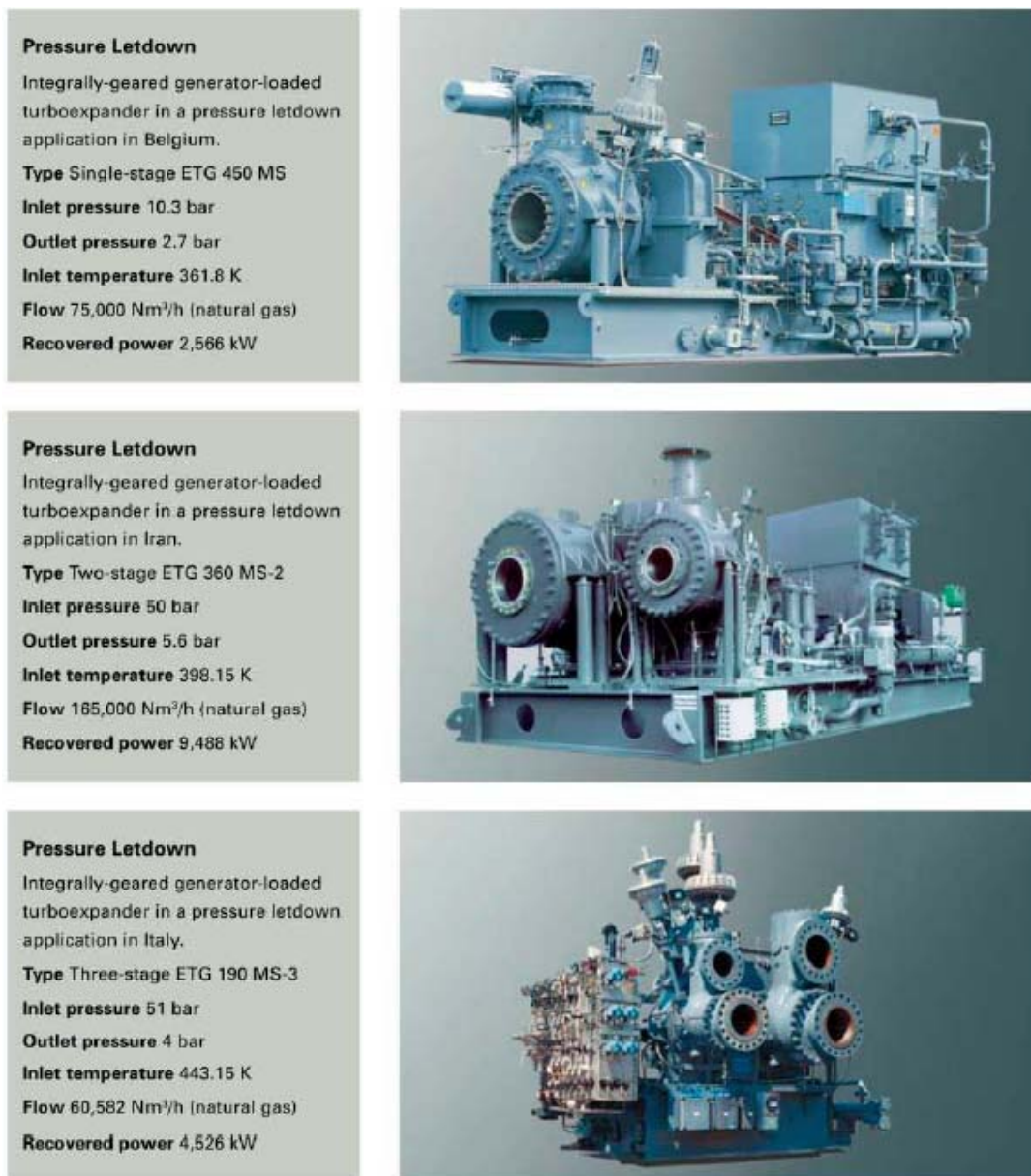
Figura 4 Características del turboexpansor – generador comercial Atlas Copco.
