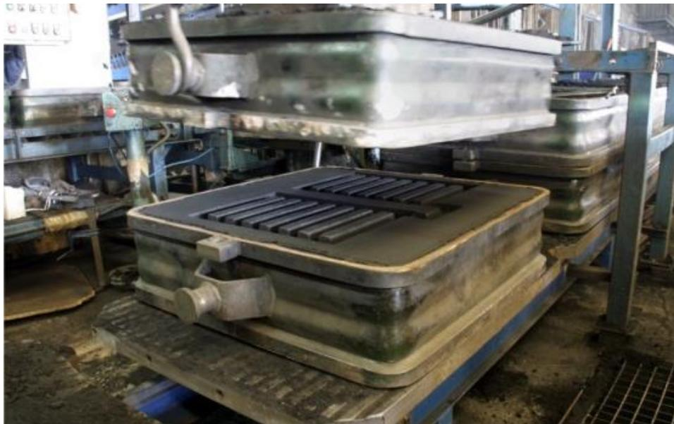
**Figura 1.8** Preparación del molde para la fundición con arena.
