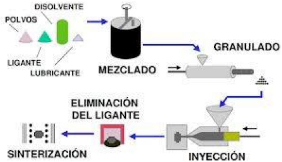
**Figura 1.14** Diagrama del proceso de sinterizado de piezas.
