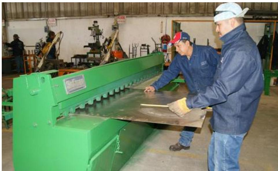
**Figura 1.20** Cizallado de láminas.
