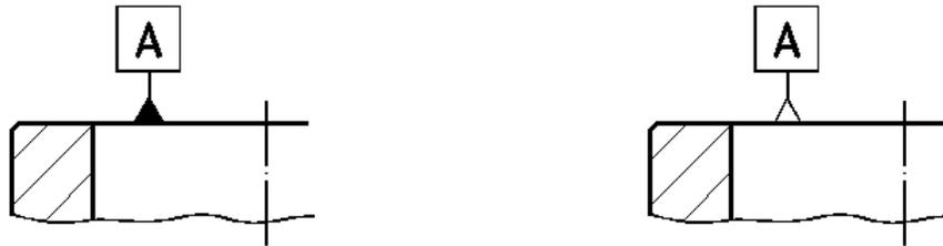
**Figura 6.6** Indicación de la referencia sobre un contorno.
