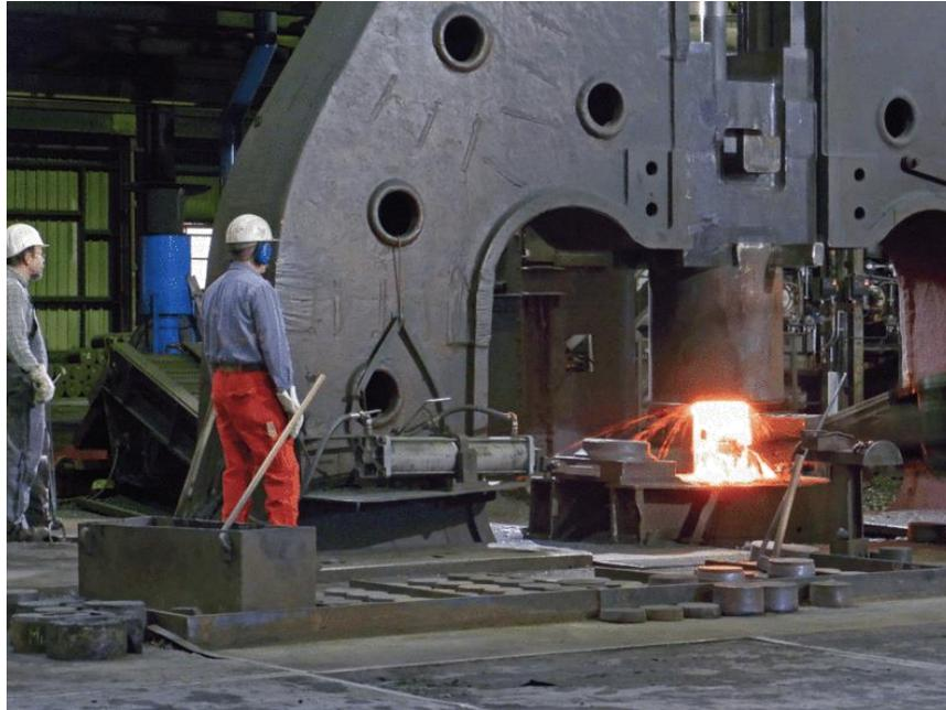
**Figura 1.26** Modelo de una prensa usada en el forjado.
