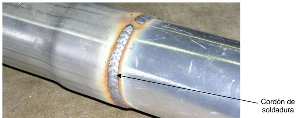
**Figura 1.54** Piezas unidas por soldadura.
