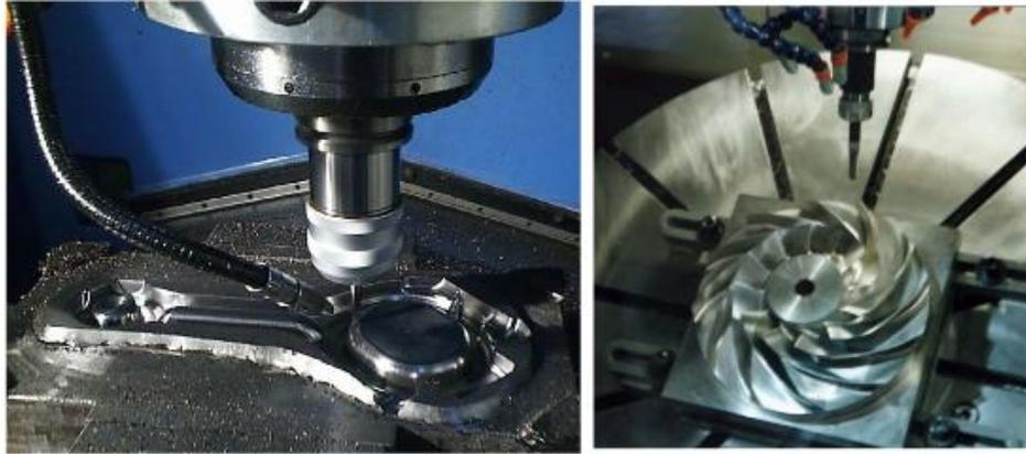
**Figura 1.43** Mecanizado de formas complejas mediante fresado.
