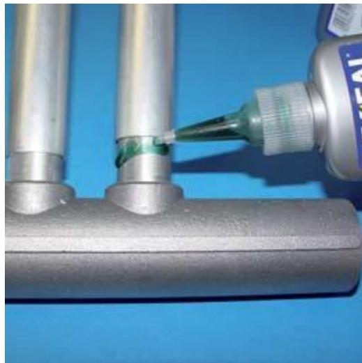
**Figura 1.55** Unión de piezas mediante pegamento.
