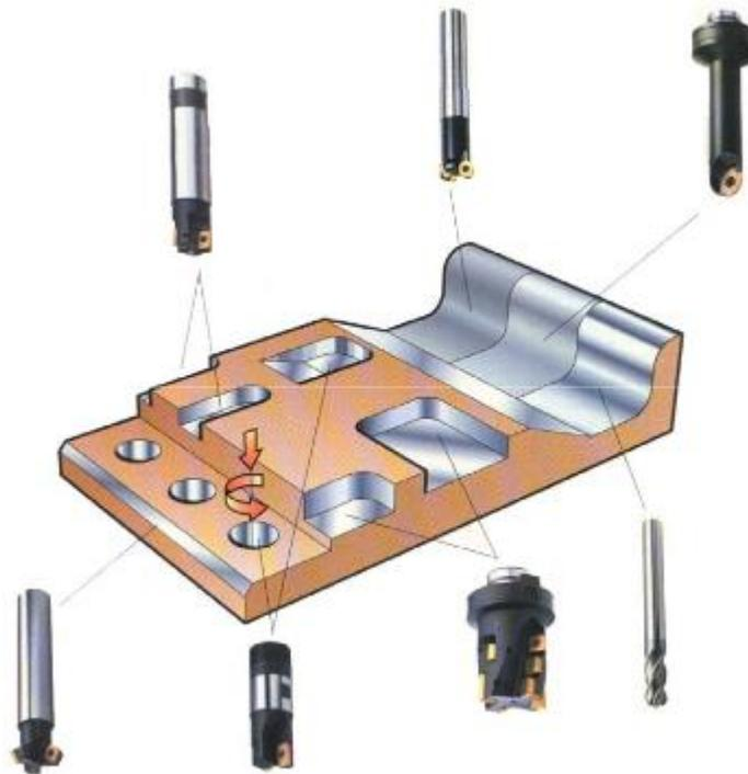
**Figura 1.41** Mecanizado de ranuras y vaciados mediante fresado.
