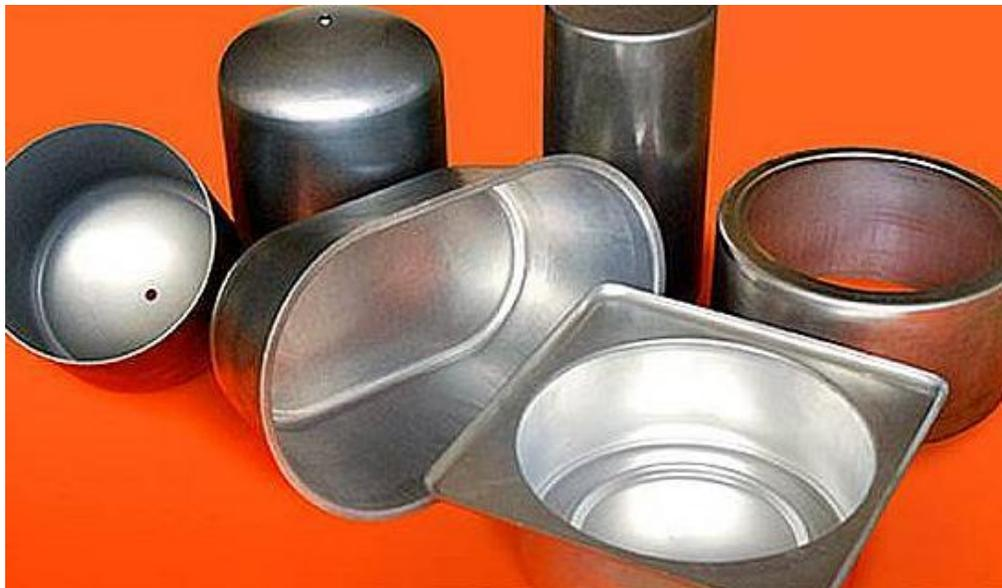
**Figura 1.22** Piezas obtenidas mediante el proceso de embutido.
