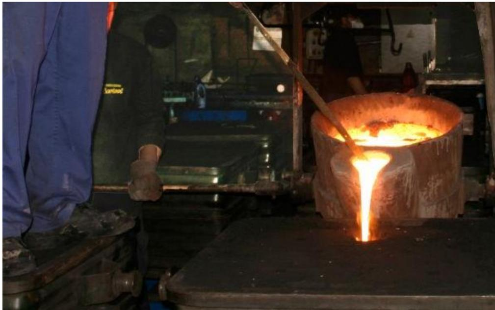
**Figura 1.9** Colada o vertido del material fundido en el molde.
