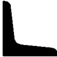
**Figura 3.50** Representación del rayado de corte en piezas con superficie reducida.
