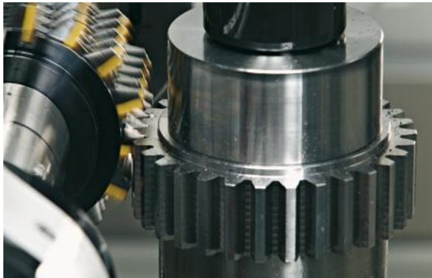
**Figura 1.42** Mecanizado de engranajes mediante fresado.
