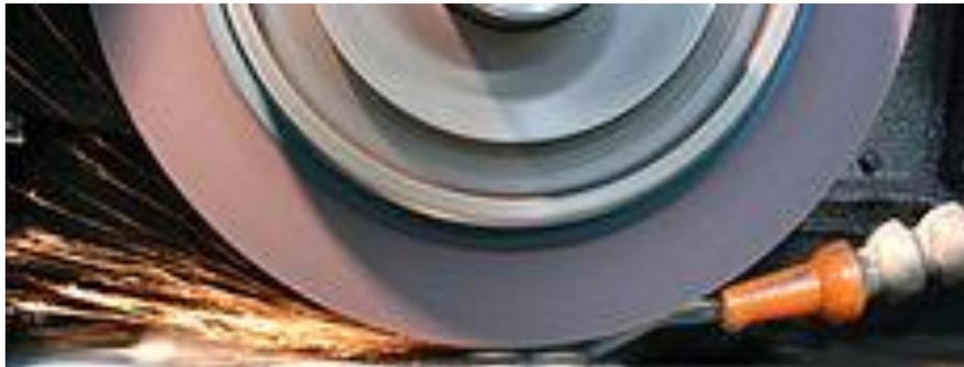
**Figura 1.48** Muela abrasiva en la operación de rectificado.
