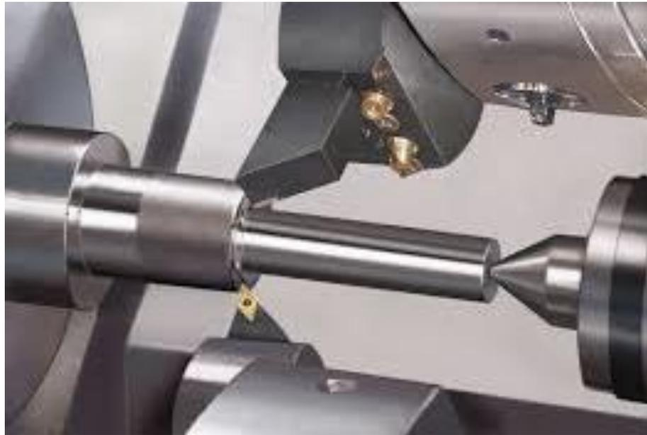
**Figura 1.30** Operación de cilindrado.
