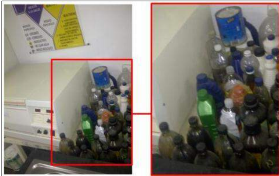
Figura 4.7 Almacenamiento incorrecto de algunos productos comerciales al lado de la centrifuga
