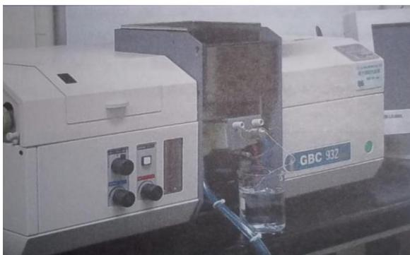
Figura 4. Espectrómetro de absorción atómica a la llama.
