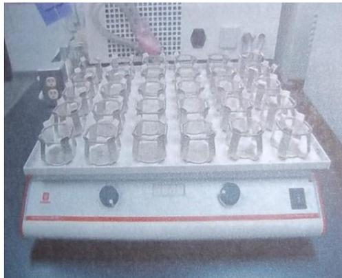
**Figura 3.** Agitador orbital. (Fuente: Laboratorio de Investigaciones Bioquímicas, FACYT-UC, 2012)
