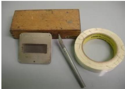
**Figura B.8** Equipo para medir adhesión
