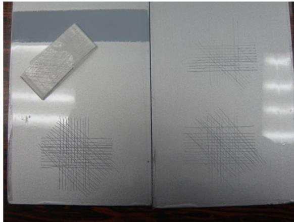
**Figura IV. 11** Laminas después de la inmersión al agua destilada a 39°C.
