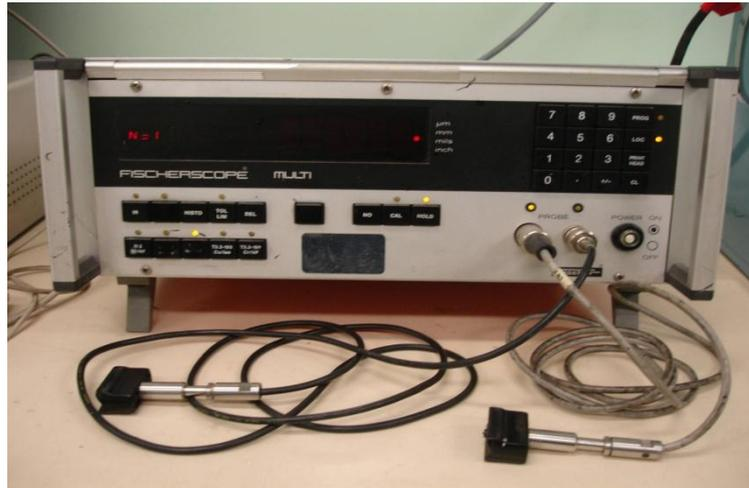
**Figura B.4** Equipo para la medición de espesores.
