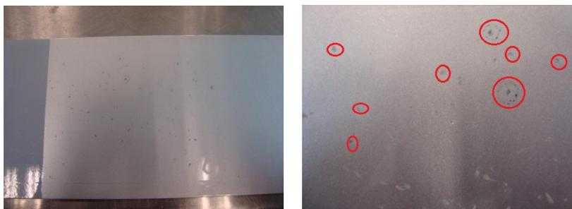
**Figura IV. 12** Resistencia al impacto con piedras a temperatura ambiente.
