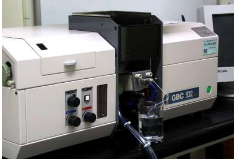
Figura 5. Espectrómetro de absorción atómica a la llama. (Fuente: Laboratorio de Análisis Instrumental, FACYT -UC, 2010)
