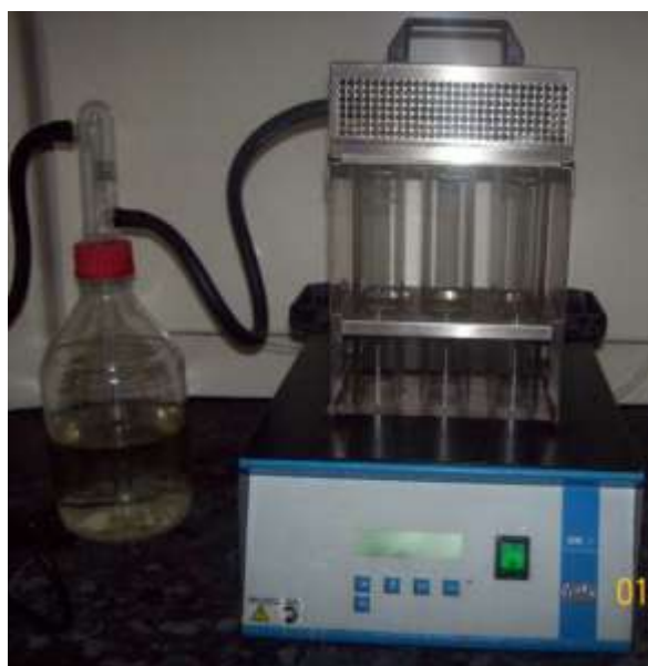
Figura 4. Bloque digestor marca Velp Scientifica DK6 con rampa de calentamiento.
