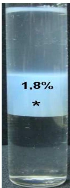
**Figura 17. Formulación óptima para el sistema SDBS/Agua/NaCl/Olefina  $\text{C}_{12}$ /1-pentanol.**
