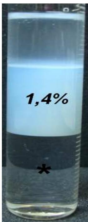
**Figura 15. Formulación óptima para el sistema SDBS/Agua/NaCl/Olefina  $C_8$ / 1-pentanol.**
