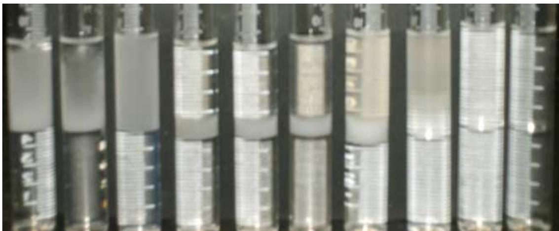
**Figura 10. Barrido de formulación del sistema SDBS/Agua/NaCl/Heptano/ Mezcla de alcoholes (70% 2-propanol y 30% 1-butanol).**
