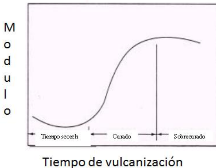
Fig. 11 Curva de curado. [10]
